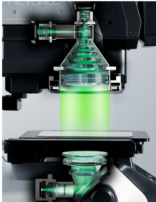
Obrázek 3.1-2 - Řez optickou soustavou přístroje Keyence [26]
