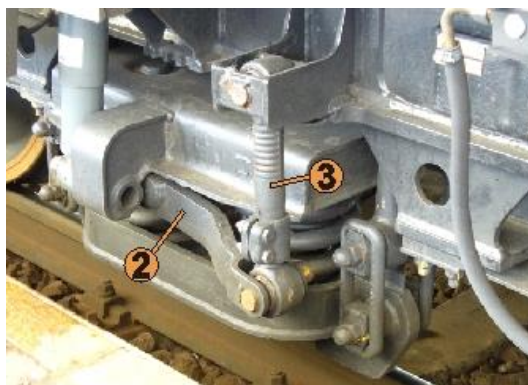
Obr. 16 Pohled na táhlo a páku torzního stabilizátoru [3]
