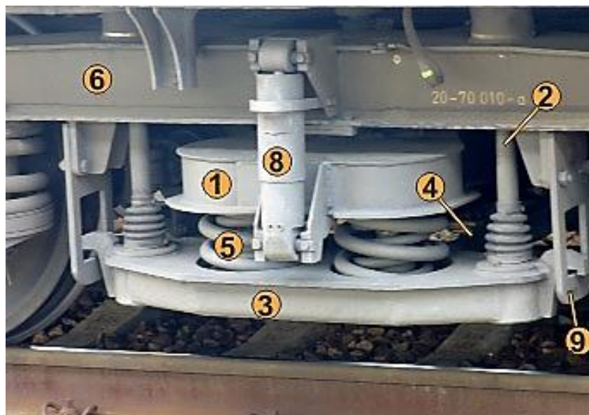
Obr. 2 Druhotné vypružení podvozku Görlitz V – Dunakeszi [3]
