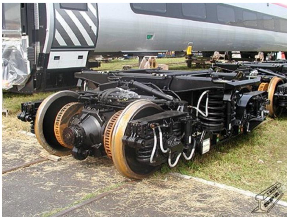
Obr. 20 Hnací podvozek ze strany nápravové převodovky [5]
