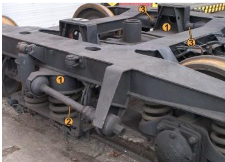
Obr. 6 Vnější táhla podvozku GP200 [3]
