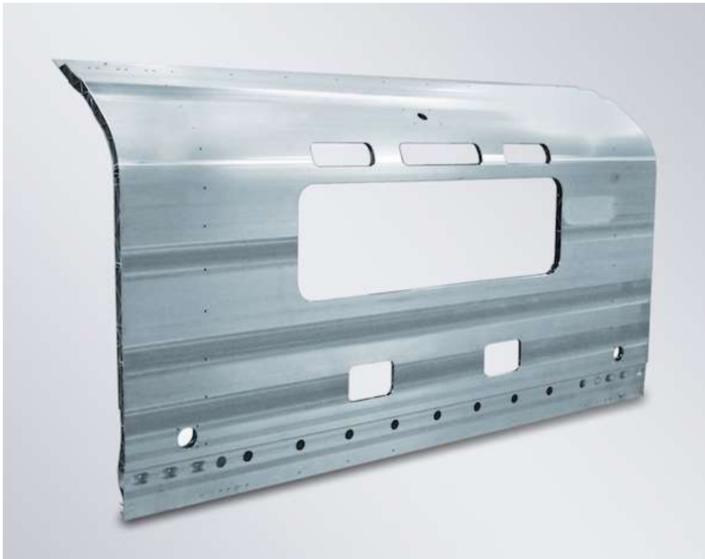
Obrázek 4 - Část skříňe kolejového vozidla z protlačovaných profilů. [8]
