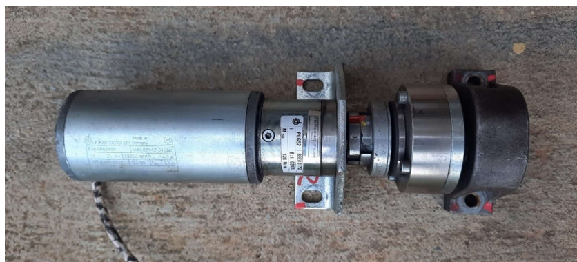
Obrázek 10 - Elektromotor firmy Dunkenmotoren používaný ve dveřních mechanismech pražského metra. Foto autor
