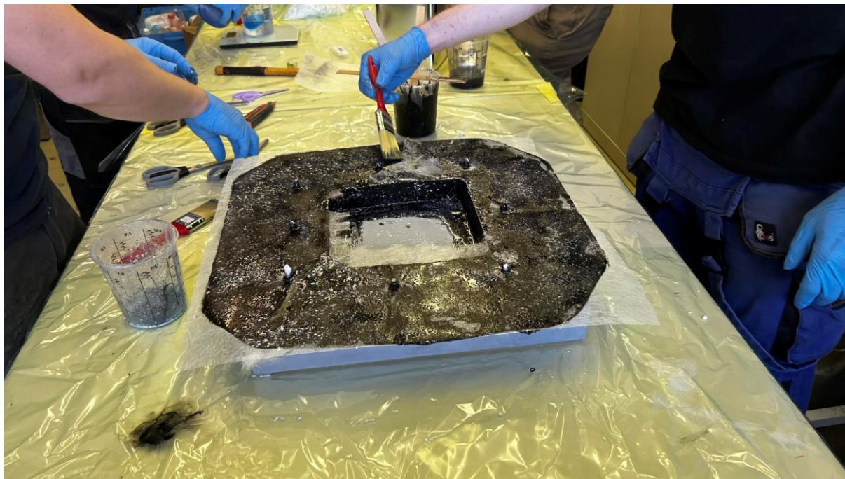
Obr. 8.6 Výroba negativní formy přední přepážky předního monocoqueu
