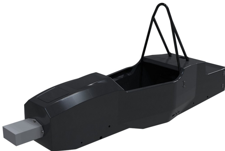
Obr. 3.3 Příklad jednodílného monocoqueu vozu Formule Student [10]
