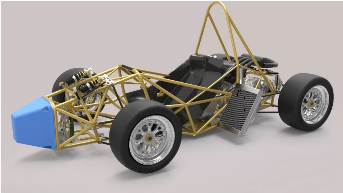
Obr. 3.2 Příklad prostorového trubkového rámu vozu Formule Student [7]
