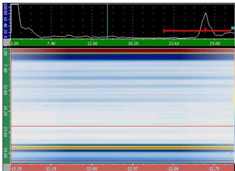
Obr. 32: Lineární a A-sken vzorku C ve směru nanášení vrstev
