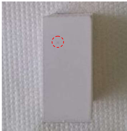
Obr. 33: Indikace přítomnosti póru na povrchu vzorku A pomocí kapilární zkoušky
