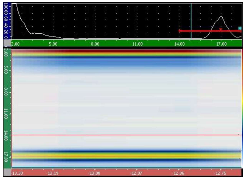
Obr. 30: Lineární a A-sken vzorku A ve směru ve směru kolmém k růstu vrstev
