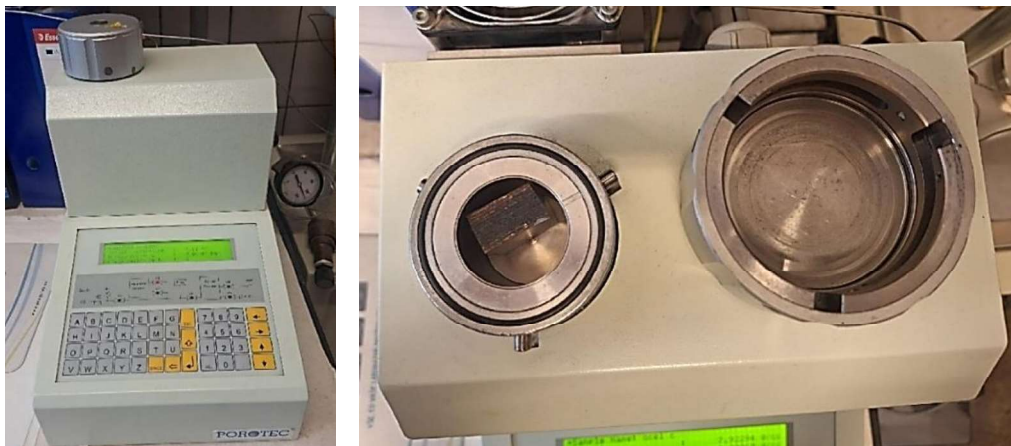
Obr. 21: Pycnometr Pycnomatic ATC (vlevo), vzorek uložený v měřicí nádobě přístroje (vpravo)
