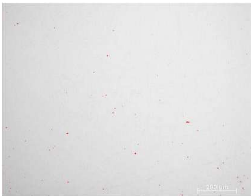
Obr. 36: Označené oblasti představující defekty (vzorek A)
