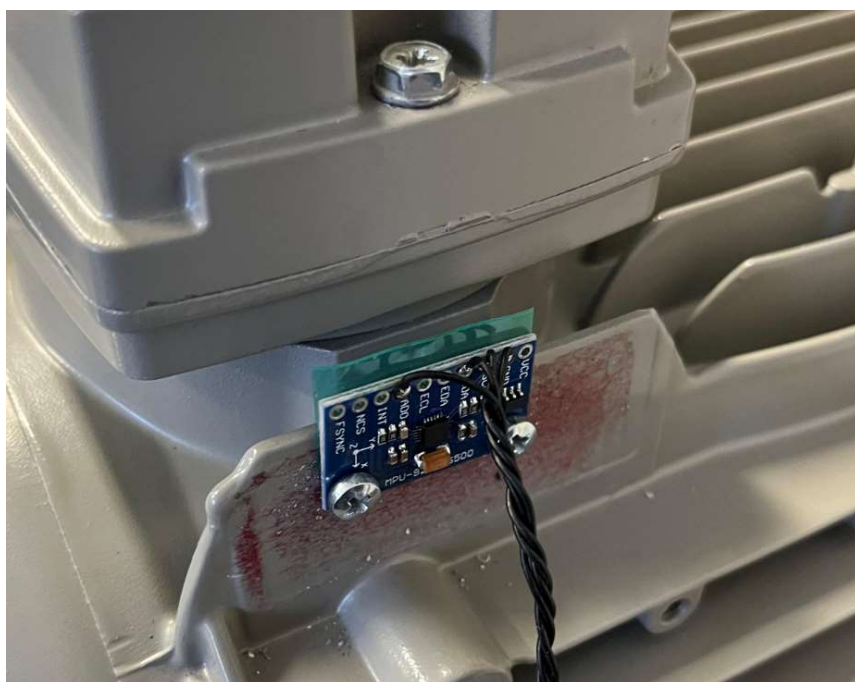
Obr. 47 Umístění druhého akcelerometru na 3f. PMSM.
