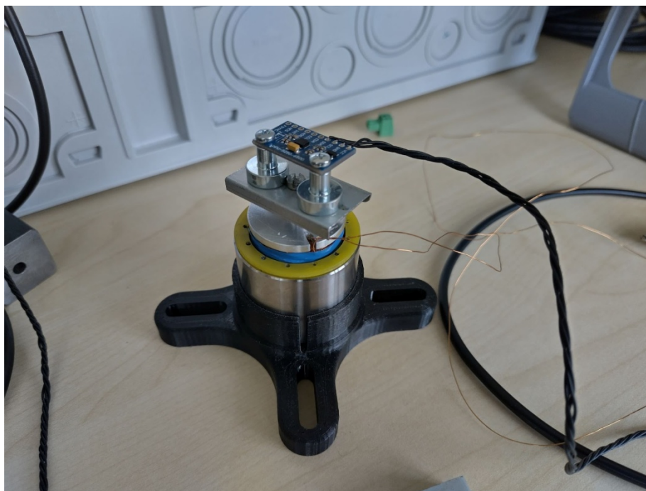
Obr. 40 Umístění akcelerometru na aktuátor
