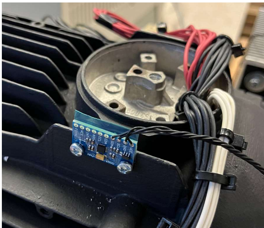
Obr. 46 Umístění prvního akcelerometru na 9f. PMSM.
