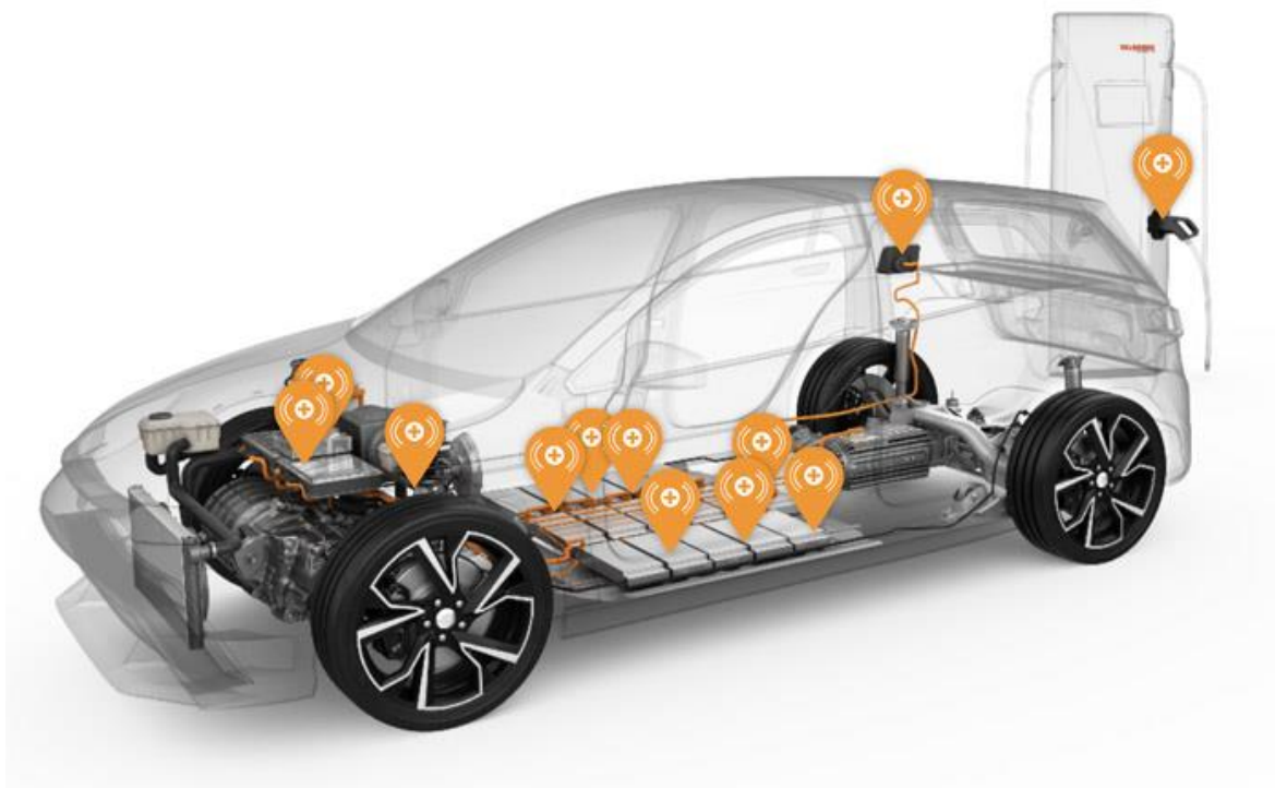
Obr. 10: Využití ultrazvukového svařování při montáži EV [28]
