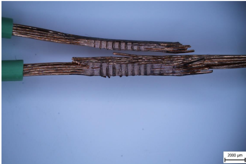
Obr. 16: Testované kabelové spojení po roztržení
