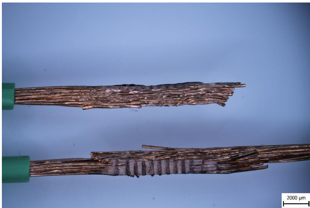
Obrázek 15: Testované kabelové spojení po roztržení
