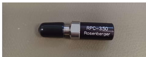
Obrázek 4.21: Precizní zakončovací rezistor o hodnotě 50 \Omega od firmy Rosenberger.
