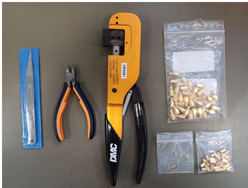
Obrázek 4.4: Potřebné vybavení pro ruční zhotovení SMA-M konektoru. Na obrázku je zleva skalpel, štípací kleště, lisovací kleště pro lowloss kabely a částmi SMA konektoru včetně jehličky.
