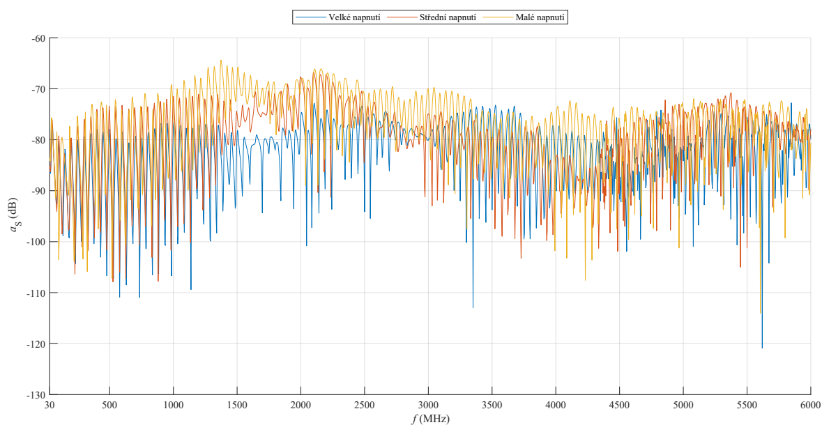
Obrázek 6.23: Průběhy útlumu stínění konektoru SMA s nízkoztrátovým kabelem N.909.934 o délce 3, 5 m ve vazební soustavě 3 m pro různá napnutí.
