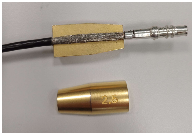
Obrázek 4.34: Odpláštěný vzorek s demontovaným krytem FAKRA vložený do upínací svorky.
