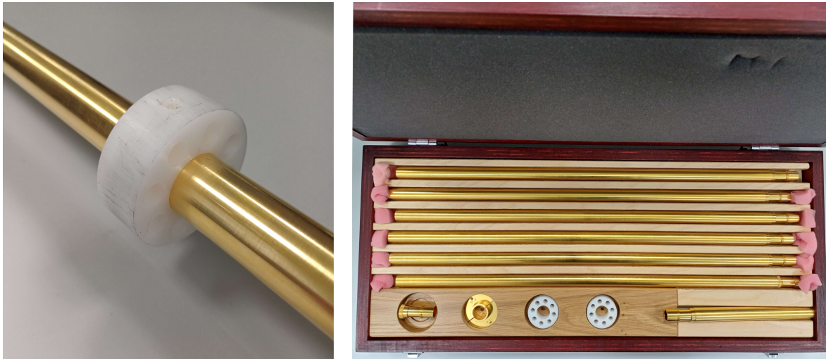
Obrázek 4.35: Přídavné vybavení pro měření metodou tube-in-tube. Vnitřní trubice s distančním kruhem je na obrázku vlevo a sada koncentrických tyčí vpravo.
