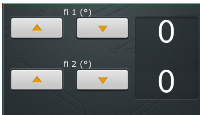
Obr. 13.2 Vytvořené grafické uživatelské rozhraní pro měření TAB, nastavují se žádané hodnoty fázových posunů
