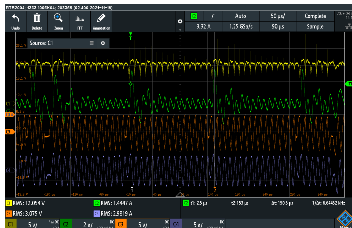
Obr. 9.6 Průběhy napětí a proudů při měření vlastností, Ch1 - V1, Ch2 - I1, Ch3 - V2, Ch4 - I2, vypočítané hodnoty vše efektivní hodnoty, měřeno při Vdc 12 V, RL = 1 Ohm, slyšitelné pískání na frekvenci 6,6 kHz
