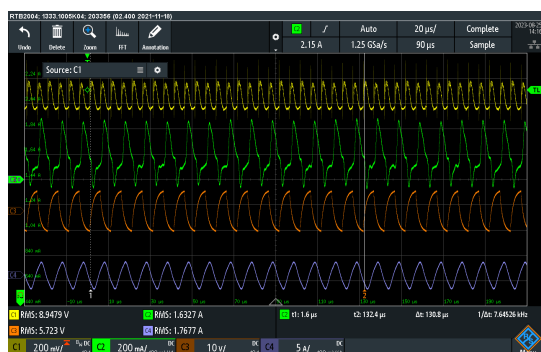
Obr. 9.12 Průběhy napětí a proudů, Ch1 - V1, Ch2 - I1, Ch3 - V2, Ch4 - I2, měřeno při Vdc 9 V, RL 3,3 Ohm, s kon- Obr. 9.13 Průběhy napětí a proudů, Ch1 - V1, Ch2 - I1, Ch3 - V2, Ch4 - I2, měřeno při Vdc 12 V, RL 3,3 Ohm, s denzátorem 470M v meziobvodu , průběhy bez kondenzátoru konzdátorem 470M v meziobvodu , zachycený podezřelý kmit se stejnými ostatními parametry jsou na obrázku 9.11
