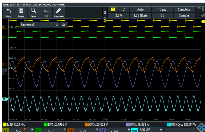
Obr. 11.6 Průběhy napětí a proudů při měření účinnosti, Ch1 - pulzy z STM horní tranzistor, Ch2 - pulzy z STM dolní tranzistor, Ch3 - V_2 , Ch4 - I_2 , Math - vypočítaný součin okamžitých hodnot V_2 a I_2 , tj. okamžitý výkon, M1 - vypočítaná okamžitá hodnota výkonu dodaného do zátěže. měřeno při V_{dc} 48 V, R_L = 1.3 Ohm, f_{pwm} = 100 kHz.
