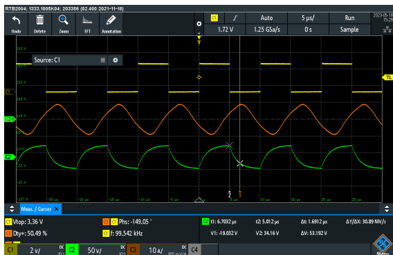
Obr. 8.18 V_{dc} = 36\text{ V} , I_{dc} = 4,6\text{ A} (proud odebíraný z DC zdroje v meziobvodu), Ch1 - pulzy z STM, Ch2 - výstupní napětí trafo (= napětí na odporové zátěži), Ch3 - proud zátěže. zátěž odpor SMD, 1R0, 5 větví (v každé 10 odporů v sérii), dvě větve v sérii, celkový odpor 4R
