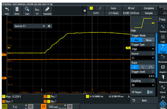
Obr. 8.6 detail náběžné hrany Vds z obrázku 8.5
