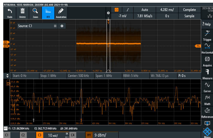
Obr. 9.3 Spektrum indukovaného napětí ve snímací cívce u napájecího DC/DC měniče
