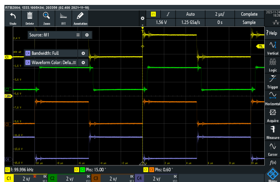
Obr. 14.2 Měření TAB, \phi_1 = 12 \text{ deg} , \phi_2 = 0 \text{ deg} , V_{dc} 12 \text{ V} , I_{dc} 3,1 \text{ A} , V_{34} 9,6 \text{ V} , I_{34} 2,48 \text{ A} , V_{56} 2,4 \text{ V} , I_{56} 0,1 \text{ A} , Ch1 - pulzy TIM1 ch1, Ch2 - pulzy TIM1 ch3, Ch3 - pulzy TIM8 ch3, Ch4 - pulzy TIM8 ch3N
