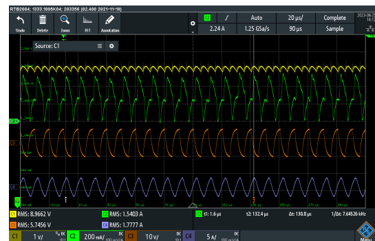
Obr. 9.11 Průběhy napětí a proudů, Ch1 - V1, Ch2 - I1, Ch3 - V2, Ch4 - I2, měřeno při Vdc 9 V, RL 3,3 Ohm, žádné pískání, uspořádání pólů nad sebou
