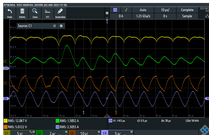
Obr. 9.5 Průběhy napětí a proudů při měření vlastností, Ch1 - V1, Ch2 - I1, Ch3 - V2, Ch4 - I2, vypočítané hodnoty vše efektivní hodnoty, měřeno při V_{dc} = 12 \text{ V} , R_L = 3.3 \text{ Ohm} , viditelné "vlnky" na I1, bez slyšitelného pískání.
