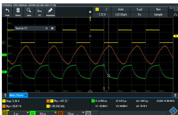
Obr. 8.20 V_{dc} = 48\text{ V} , I_{dc} = 6,1\text{ A} (proud odebíraný z DC zdroje v meziobvodu), Ch1 - pulzy z STM, Ch2 - výstupní napětí trafo (= napětí na odporové zátěži), Ch3 - proud zátěže. zátěž odpor SMD, 1R0, 5 větví (v každé 10 odporů v sérii), dvě větve v sérii, celkový odpor 4R
