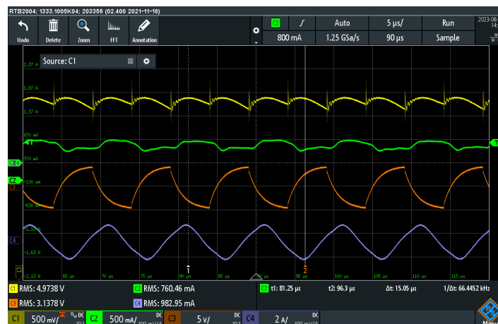
Obr. 9.7 Průběhy napětí a proudů při měření vlastností, Ch1 - V1, Ch2 - I1, Ch3 - V2, Ch4 - I2, vypočítané hodnoty vše efektivní hodnoty, měřeno při V_{dc} = 5 \text{ V} , R_L = 3.3 \text{ Ohm} , průběh bez problémů
