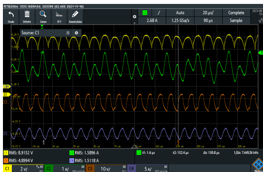
Obr. 9.10 Průběhy napětí a proudů, Ch1 - V1, Ch2 - I1, Ch3 - V2, Ch4 - I2, měřeno při Vdc 9 V, RL 3,3 Ohm, slyšitelné pískání, uspořádání pólů vedle sebe
