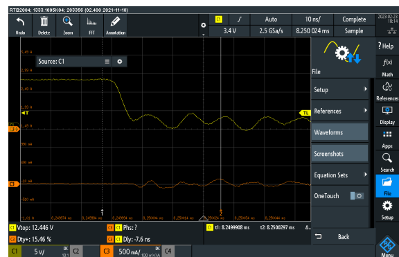
Obr. 8.7 detail sestupné hrany Vds z obrázku 8.5
