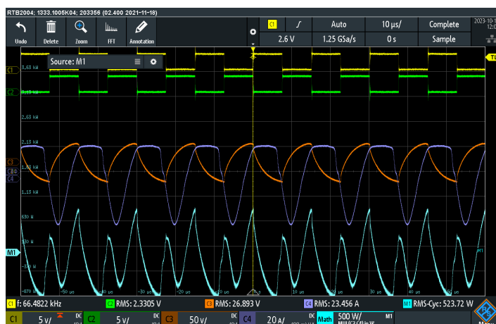
Obr. 11.8 Průběhy napětí a proudů při měření účinnosti, Ch1 - pulzy z STM horní tranzistor, Ch2 - pulzy z STM dolní tranzistor, Ch3 - V2, Ch4 - I2, Math - vypočítaný součin okamžitých hodnot V2 a I2, tj. okamžitý výkon, M1 - vypočítaná okamžitá hodnota výkonu dodaného do zátěže. měřeno při V_{dc} 48 V, R_L = 1.2 Ohm, f_{pwm} = 66 kHz.
