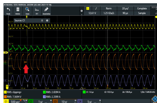
Obr. 9.12 Průběhy napětí a proudů, Ch1 - V1, Ch2 - I1, Ch3 - V2, Ch4 - I2, měřeno při Vdc 9 V, RL 3,3 Ohm, s kon- Obr. 9.13 Průběhy napětí a proudů, Ch1 - V1, Ch2 - I1, Ch3 - V2, Ch4 - I2, měřeno při Vdc 12 V, RL 3,3 Ohm, s denzátorem 470M v meziobvodu , průběhy bez kondenzátoru konzdátorem 470M v meziobvodu , zachycený podezřelý kmit se stejnými ostatními parametry jsou na obrázku 9.11
