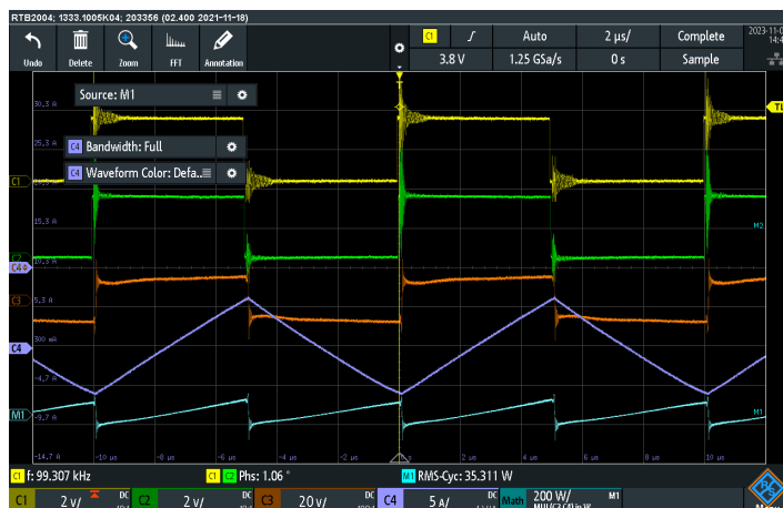
Obr. 12.16 průběhy při V_{dc} = 48 \text{ V} , f_{pwm} = 100 \text{ kHz} , R_{load} = 3R_9 , kanály: Ch1 - pulzy vrchní tranzistor půlmůstek 1, Ch2 - pulzy vrchní tranzistor půlmůstek 3, Ch3 - napětí na sekundárním vinutí trafo (měřeno diferencíální napěťovou sondou), Ch4 - proud sekundárním vinutím trafo (měřeno proudovou sondou), Math - \text{Ch3} \times \text{Ch4} = okamžitý výkon sekundárním vinutím
