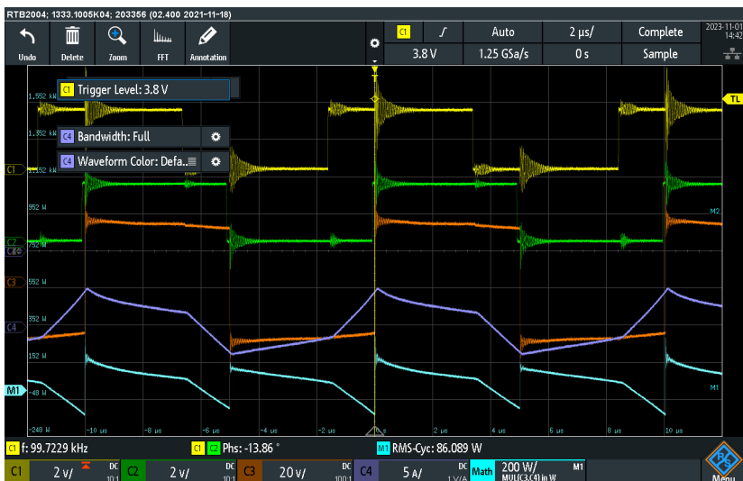
Obr. 12.12 průběhy při V_{dc} = 24 \text{ V} , f_{pwm} = 100 \text{ kHz} , R_{load} = 3R_9 , kanály: Ch1 - pulzy vrchní tranzistor půlmůstek 1, Ch2 - pulzy vrchní tranzistor půlmůstek 3, Ch3 - napětí na sekundárním vinutí trafo (měřeno diferencíální napěťovou sondou), Ch4 - proud sekundárním vinutím trafo (měřeno proudovou sondou), Math - Ch3 \times Ch4 = okamžitý výkon sekundárním vinutím
