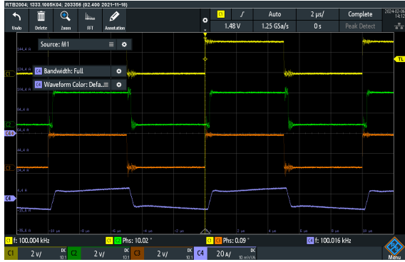
Obr. 14.8 Měření TAB, při V_{dc}=48 V, I_{dc}=8,6 A, P_{in}=412 W, P_{out}=386 W, oba výstupní můstky připojené na odporovou zátěž 3R9 resp. 7R8, Ch1 - řídicí signál půlmůstků 1 a 2 (TIM1 Ch1), ch2 - řídicí signál půlmůstků 3 a 4 (TIM1 Ch3), ch3 - řídicí signál půlmůstků 5 a 6 (TIM8 Ch3), ch4 - Itrafa
