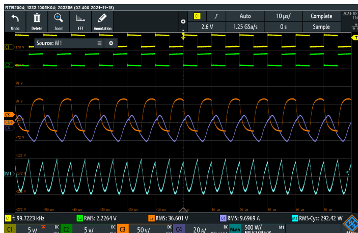
Obr. 11.5 Průběhy napětí a proudů při měření účinnosti, Ch1 - pulzy z STM horní tranzistor, Ch2 - pulzy z STM dolní tranzistor, Ch3 - V_2 , Ch4 - I_2 , Math - vypočítaný součin okamžitých hodnot V_2 a I_2 , tj. okamžitý výkon, M1 - vypočítaná okamžitá hodnota výkonu dodaného do zátěže. měřeno při Vdc 48 V, R_L = 3.9 Ohm, f_{pwm} = 100 kHz.
