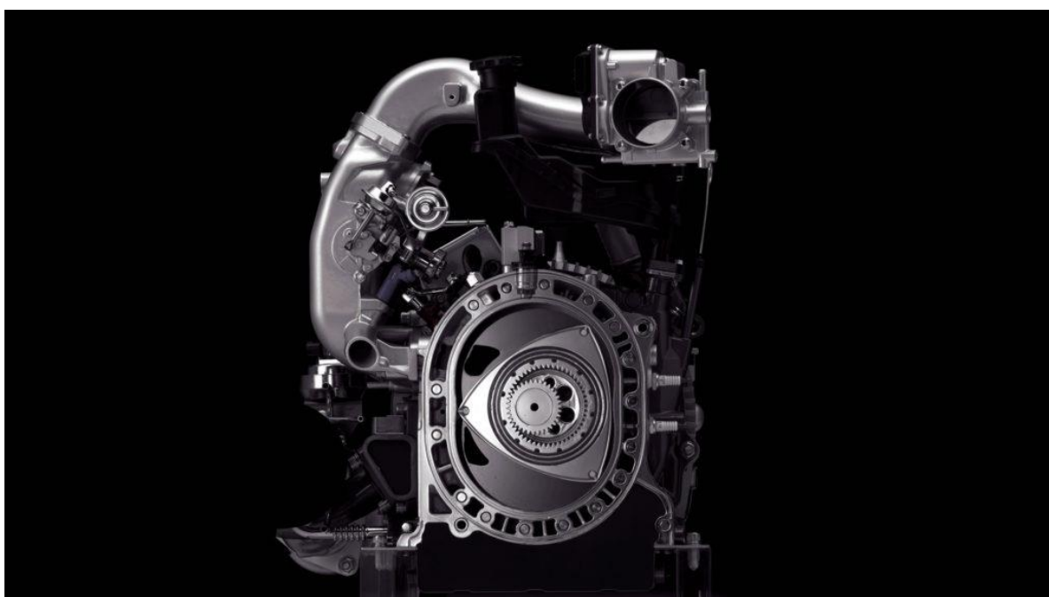
Obrázek 12 - Wankelův spalovací motor Mazdy RX-8 Hydrogen RE
