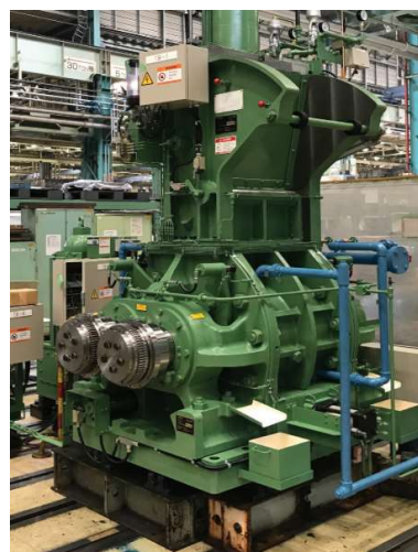
Obr. 21 Paralelní pohon mixéru pomocí zubových spojek [16]
