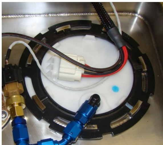
Obr. 28 Příruba spojená s nádrží [25]
