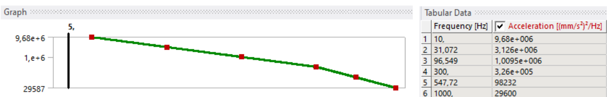
Obr. 55 Hodnoty náhodných vibrací
