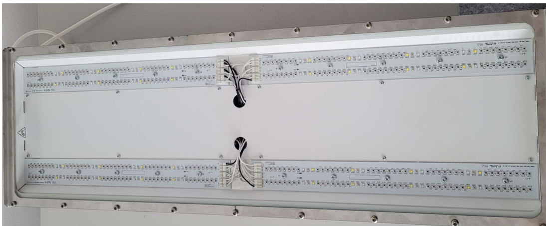
Obrázek 8: Konkrétní příklad DALI osvětlení pro účely pěstování plodin (model od firmy Food Autonomy)
