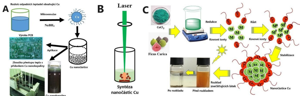
Obr. 6: A. Metoda mikroemulze B. Metoda pulsní laserové ablace C. Biosyntéza Cu nanočástic [20, 22–24]
