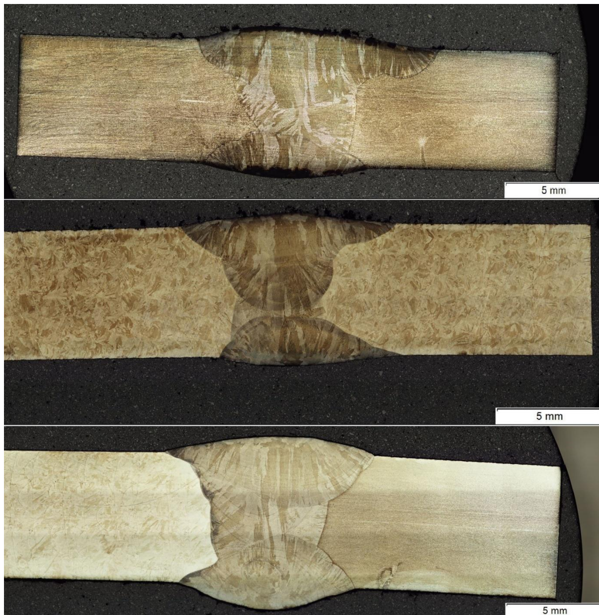
Obr. 51: Metoda 141; nahoře válcovaný, uprostřed DED, dole přechodový spoj; zvětšeno 50x
