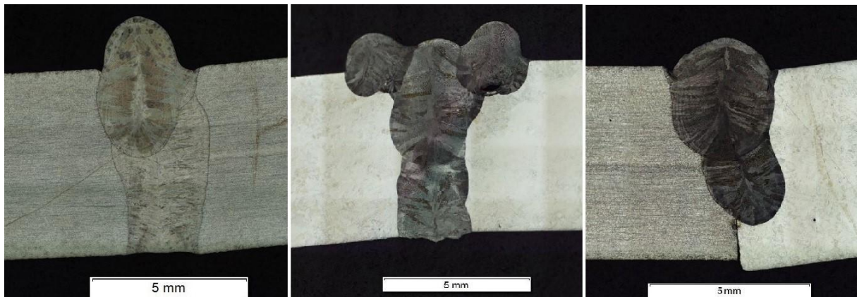
Obr. 53: Metoda 521 Cold wire; vlevo válcovaná, uprostřed DED, vpravo přechodový spoj; zvětšeno 50x
