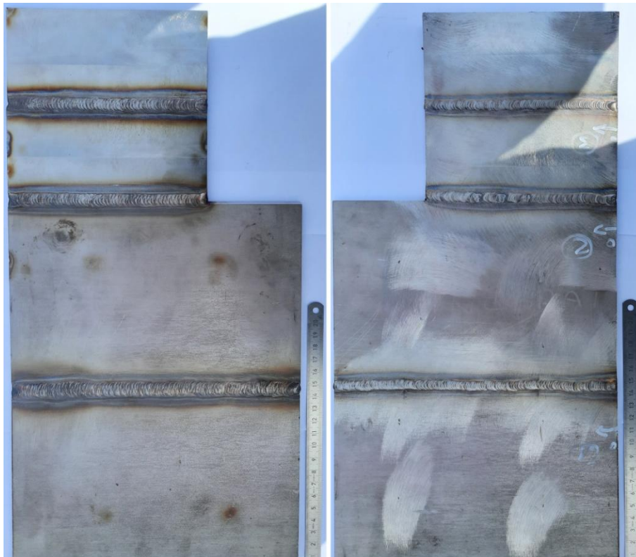
Obr. 30: Svařenec opakované metody 141, vlevo líc, vpravo kořen; kratší plechy DED, delší válcovaná ocel
