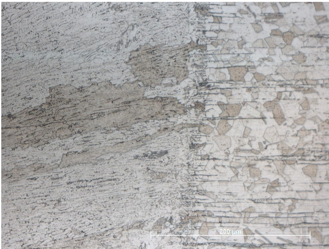
Obr. 62: Detail hranice ztavení svaru válcované oceli; metoda 521 Cold wire; zvětšeno 200x
