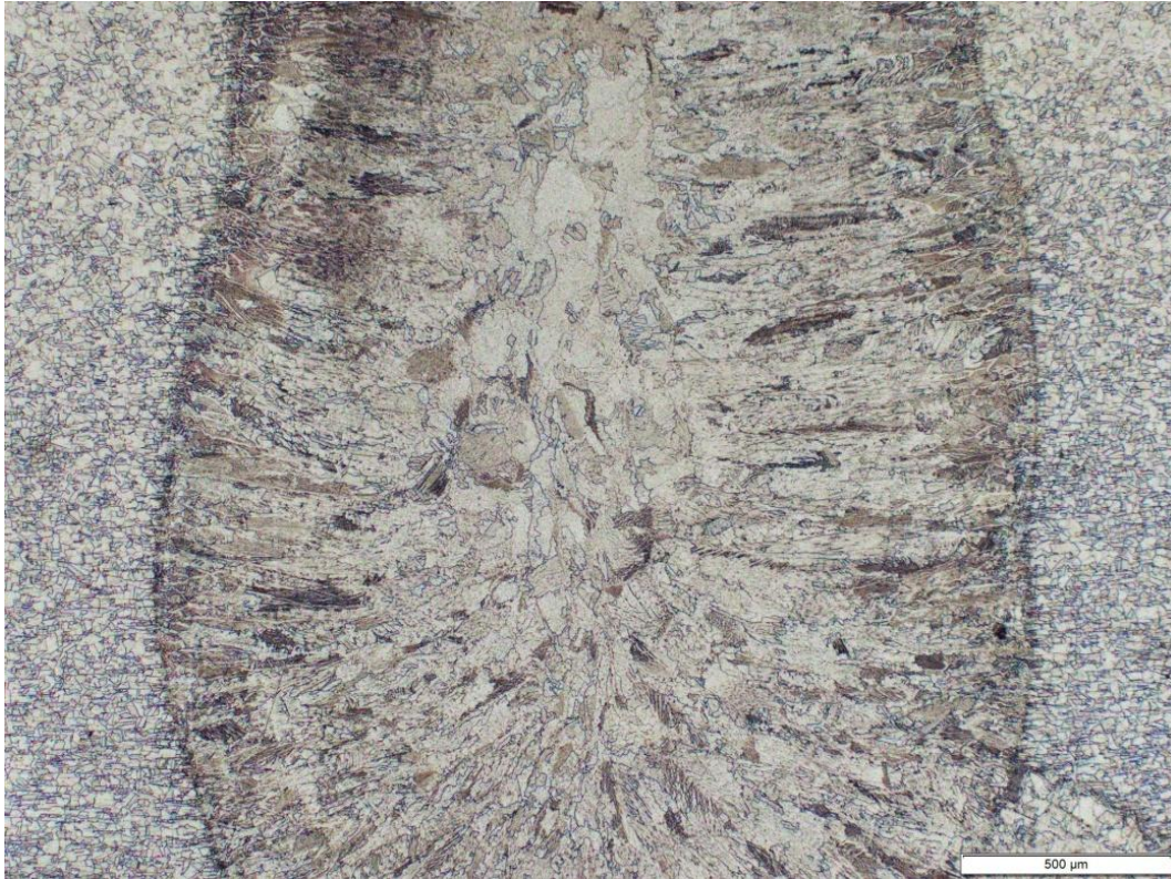
Obr. 58: Mikrostruktura svaru válcované oceli; metoda 521; zvětšeno 50x
