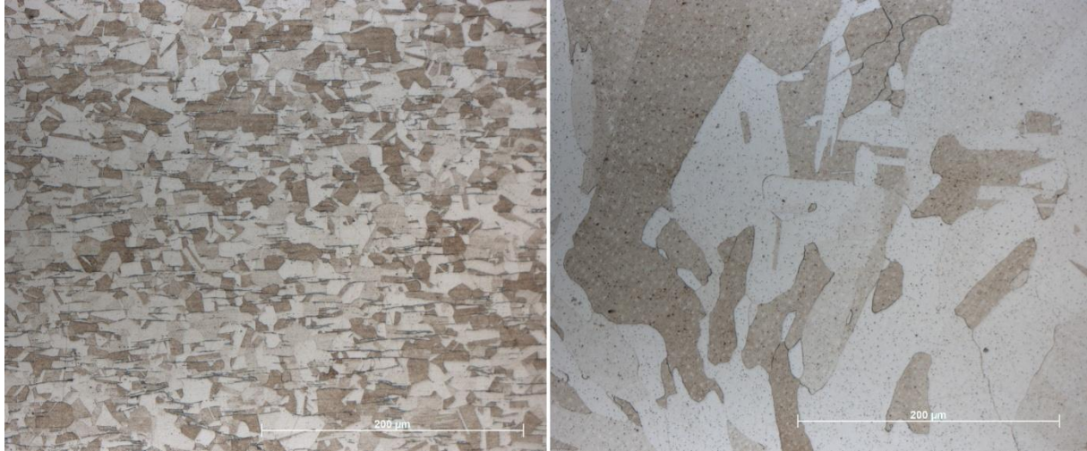
Obr. 63: Základní materiál; vlevo válcovaná, vpravo DED ocel; zvětšeno 200x
