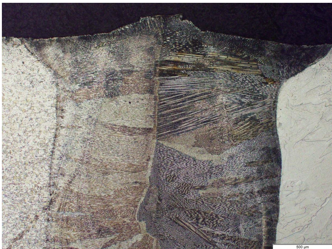
Obr. 60: Mikrostruktura přechodového svaru; metoda 521; zvětšeno 50x
