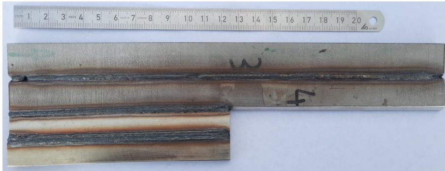
Obr. 39: Svařec; metoda 521 Cold wire; líc svaru
