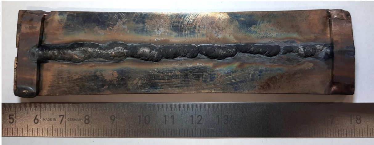
Obr. 25: Nevyhovující kořen svaru DED oceli
