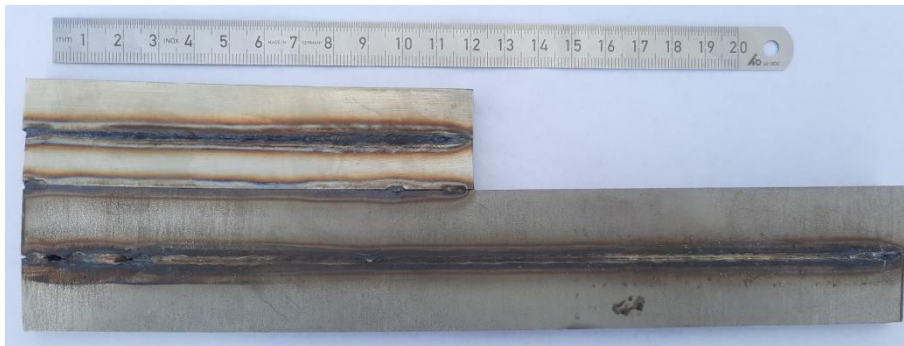
Obr. 40: Svařec; metoda 521 Cold wire; kořen svaru
