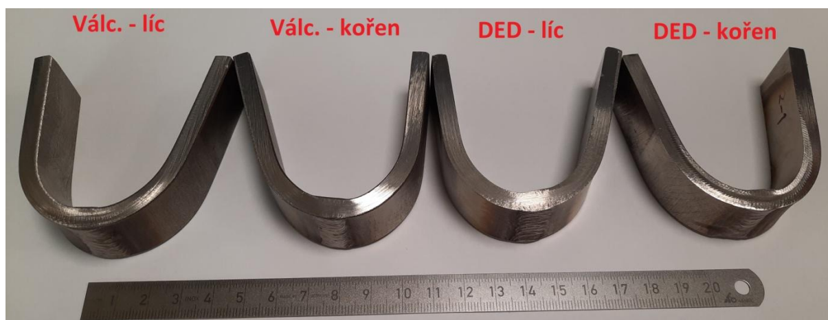
Obr. 82: Vzorky po ohybové zkoušce; vlevo válcovaná, vpravo DED ocel; metoda 141
