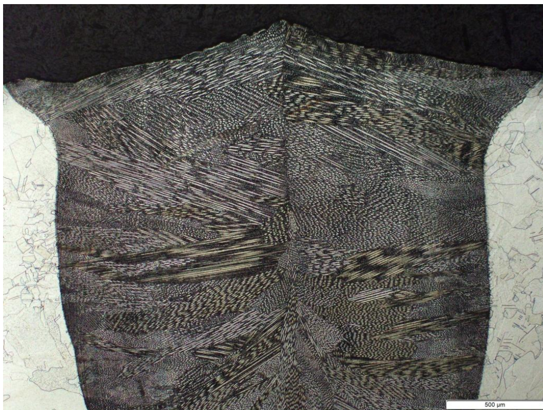
Obr. 59: Mikrostruktura svaru DED oceli; metoda 521; zvětšeno 50x
