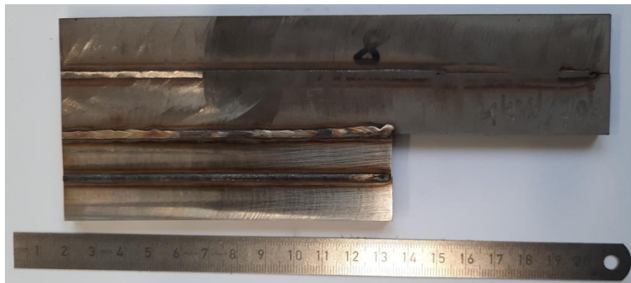
Obr. 35: Strana B vzorků svařených natupo metodou 521
