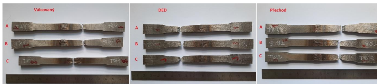
Obr. 70: Přetržené vzorky po statické tahové zkoušce; metoda 141 (opakování)
