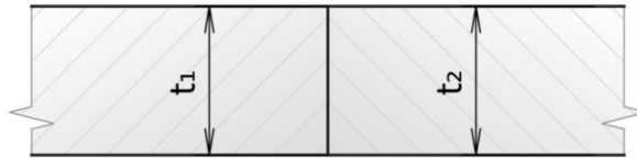
Obr. 32: Příprava plechů pro laserové svařování bez přídavného drátu
