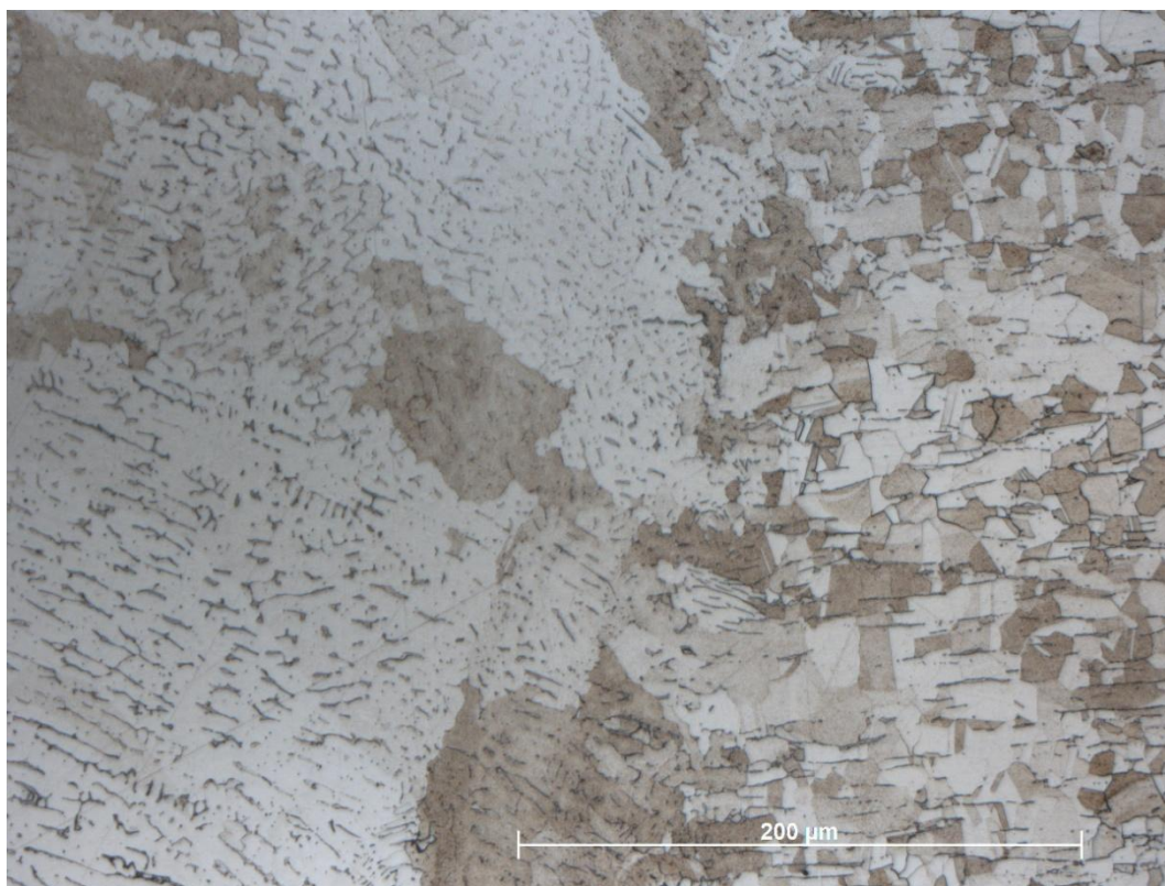
Obr. 57: Detail hranice ztavení svaru válcované oceli; metoda 141; zvětšeno 200x
