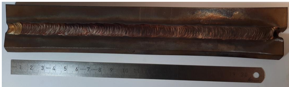
Obr. 23: Svarový spoj – válcovaná ocel 316L; metoda 141
