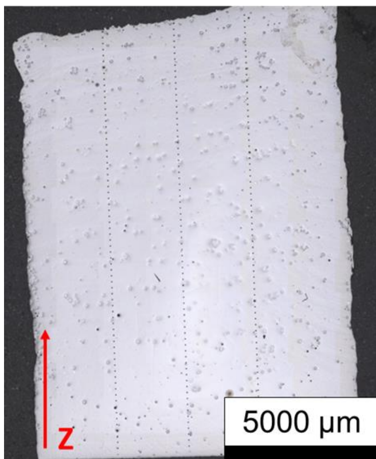
Obr. 34: Mikročistota slitiny s gradientem složení \text{CrNbTiZr} \rightarrow \text{CrNbTi}_2\text{Zr} ve stavu as-deposited. Snímek pořízený pomocí OM.
