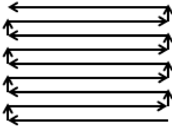
Obr. 19: Trajektorie pohybu depoziční hlavičky při tisku výplně.
