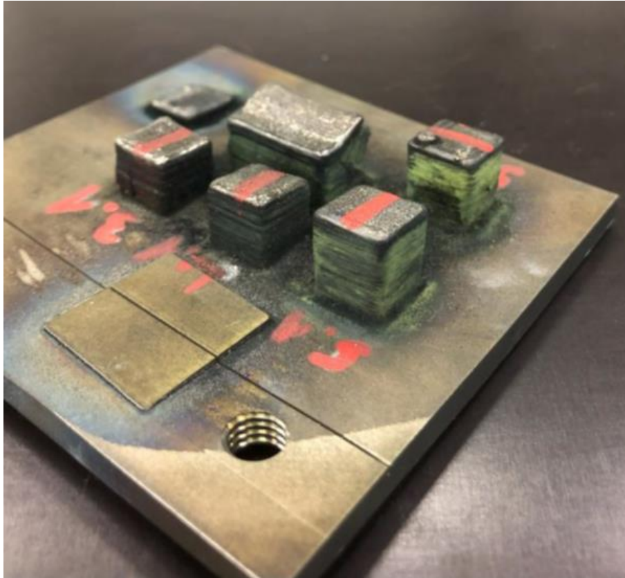
Obr. 17: Vzorky ze slitiny CrNbTiZr po depozici. Jsou publikovány výsledky analýzy vzorku 5.1, tj. nejbližše ke čtenáři. Ostatní vzorky sloužily k optimalizaci parametrů a nejsou v této práci zahrnuty.
