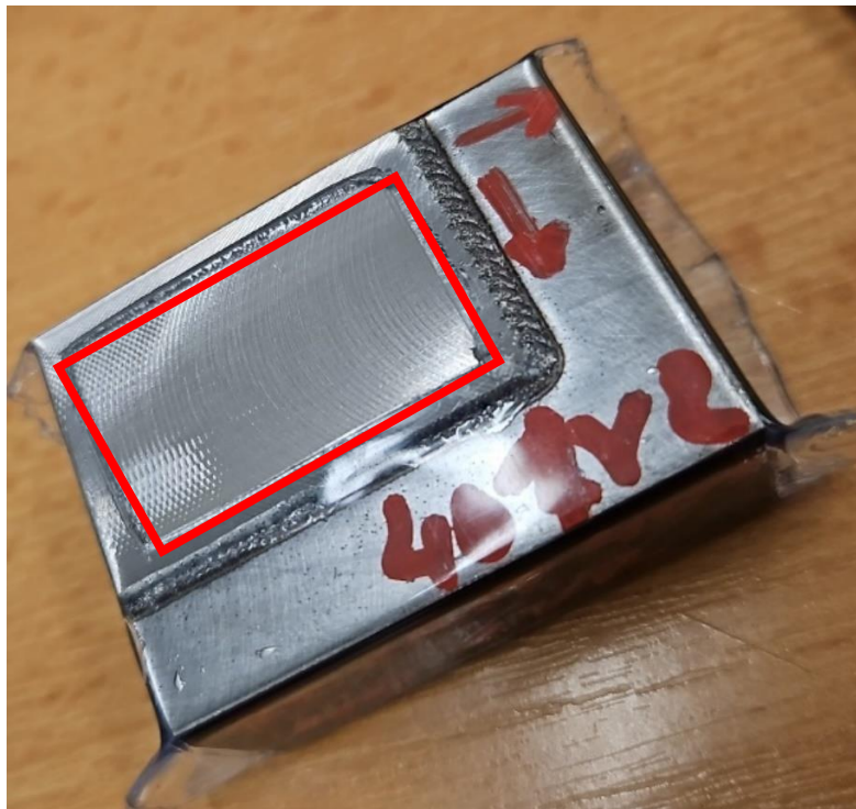
Obrázek 29 - Vzorek laserového návaru ochráněný PVC vodotěsnou páskou, červeně vyznačena oblast připravené k expozici v koroznímu testu
