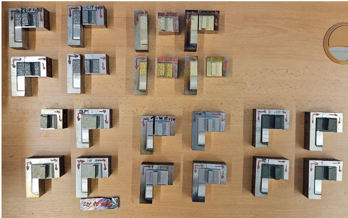
Obrázek 16 - Průběh separace vzorků pro korozní test
