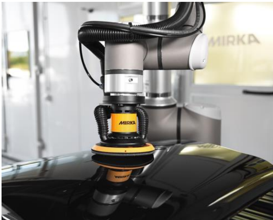
Obrázek 28: [32] Brusná hlava Mirka airos na kolaborativním robotu Universal Robots
