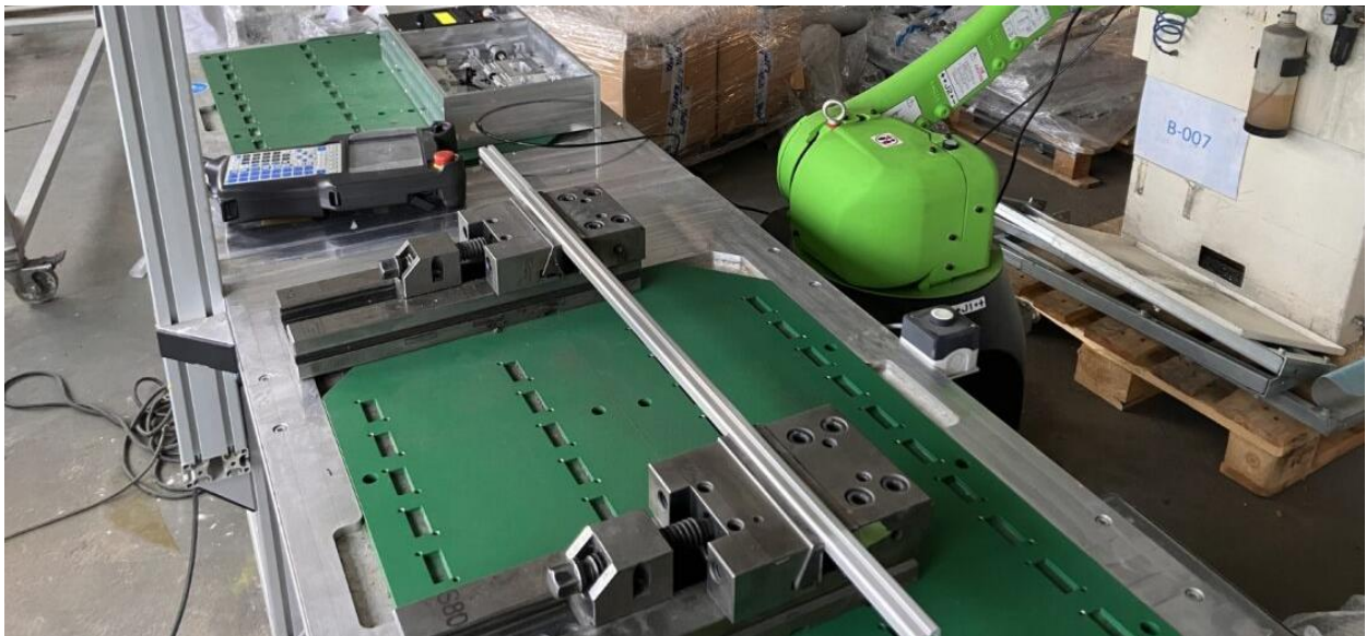
Obrázek 40: Upínání obrobku pomocí strojních svěráků GERARDI 1-3X200
