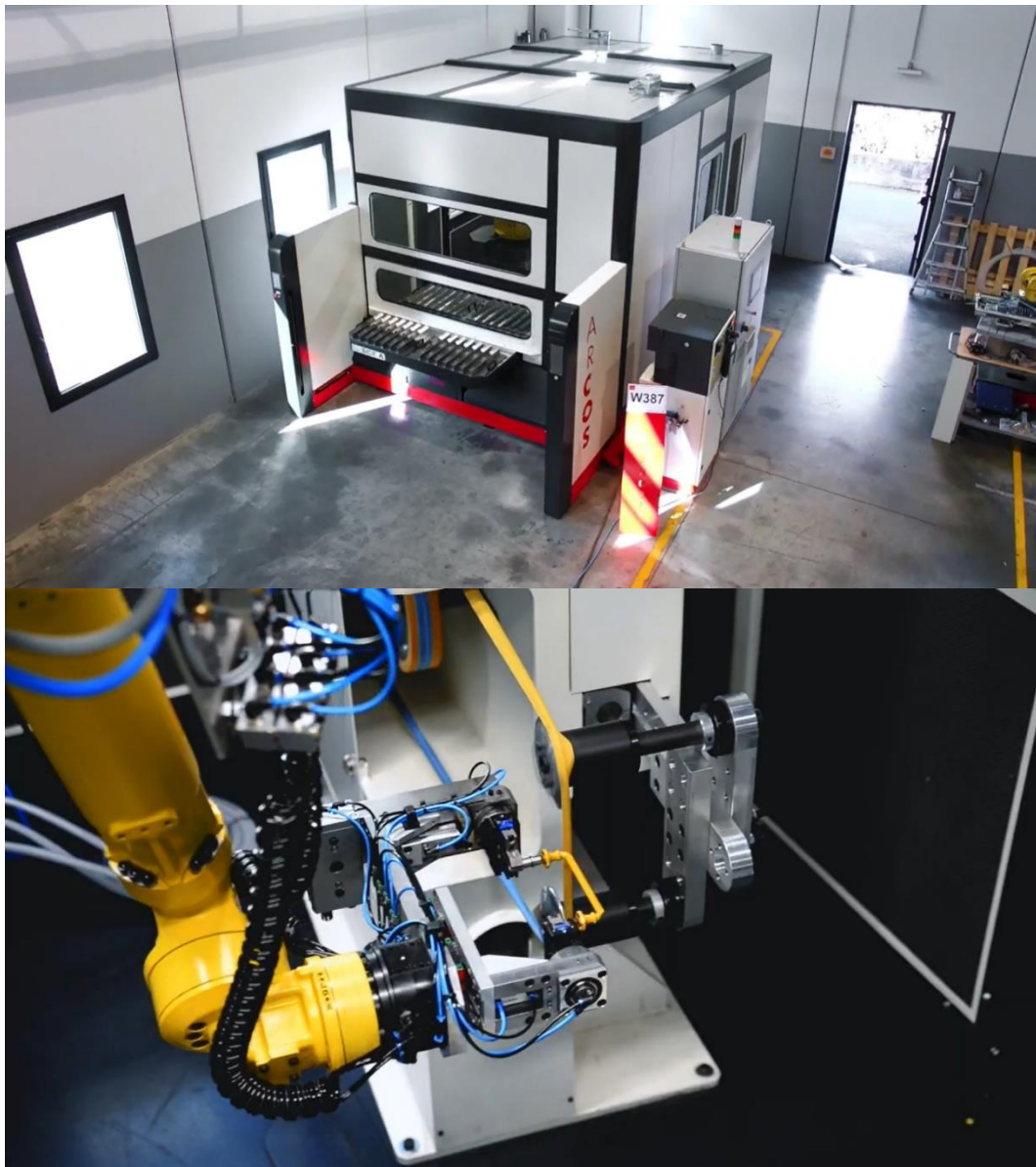
Obrázek 27: Arcos USA: buňka pro automatické broušení a leštění model. Zakládání pomocí otočného stolu s přípravkem, robot je vybaven koncovým efektem s rozšiřující rotační pohybovou osou pro otáčení obrobků.[28]
