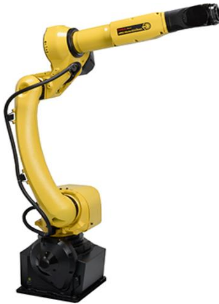
Obrázek 10: Svařovací průmyslový robot FANUC ARC Mate 100iD/10L [10]
