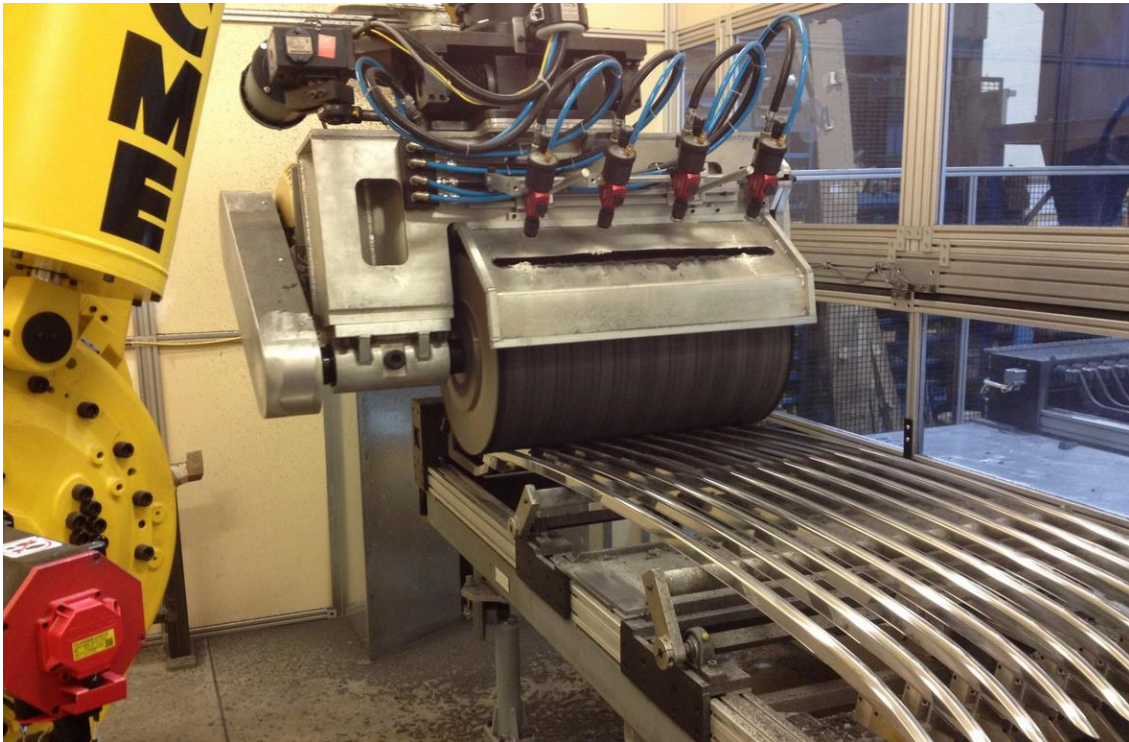
Obrázek 22: Aplikace tool in hand: ACME- leštění okrasných lišt pro automobily [22]
