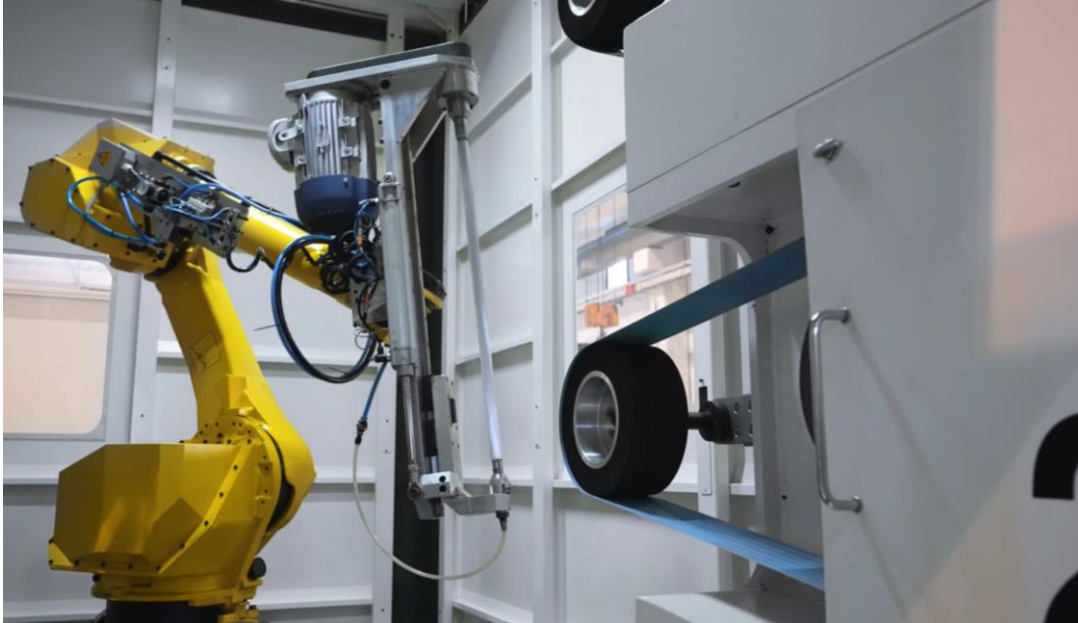
Obrázek 23: Aplikace part in hand: Arcos- obvodové broušení vnější válcové plochy hlavně brokovnice, vnitřní chlazení obrobku kapalinou [23]
