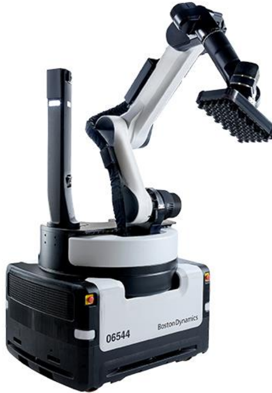
Obrázek 3: Mobilní průmyslový robot Boston Dynamics Stretch s kolovým podvozkem, určený pro vykládání krabic z nákladních automobilů[5]
