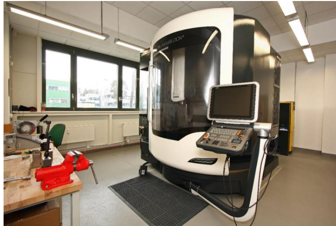
Obr. 24: Pětiosé frézovací centrum DMU 65 monoBlock [1]
