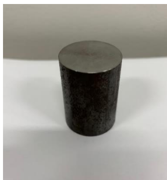
Obr. 26: Zkušební váleček pro měření řezných sil
