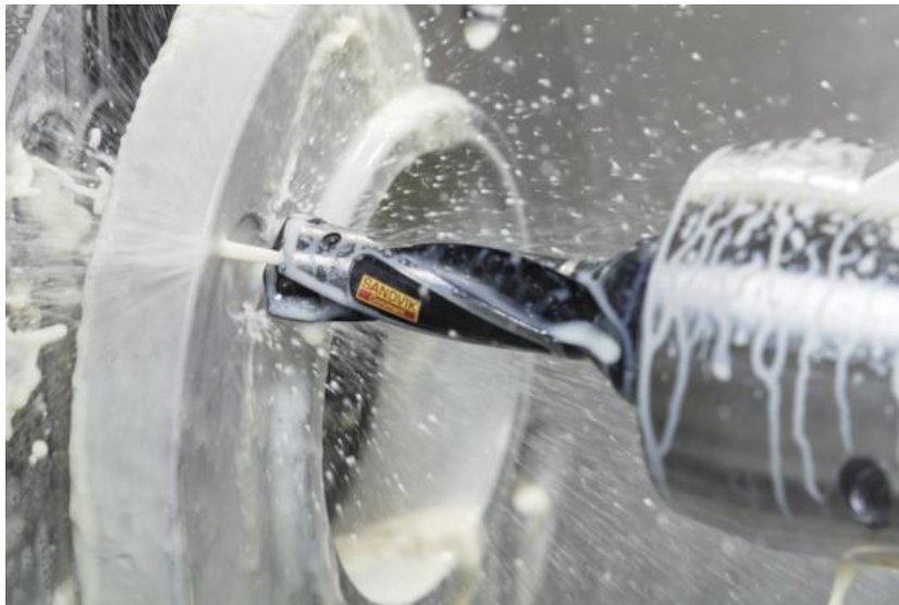
Obr. 1: Aplikace vnitřního systému chlazení u vrtáku firmy Sandvik Coromant [7]
