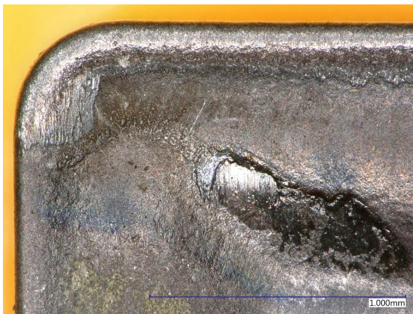
Obr. 38: Čelo vnější VBD Ref. nástroje po 10 otvorech
