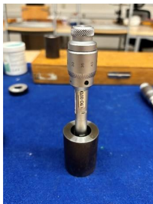
Obr. 46: Měření průměru zkušebního vzorku
