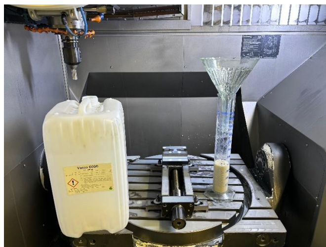
Obr. 30: Měření průtočného množství kapaliny nástrojem
