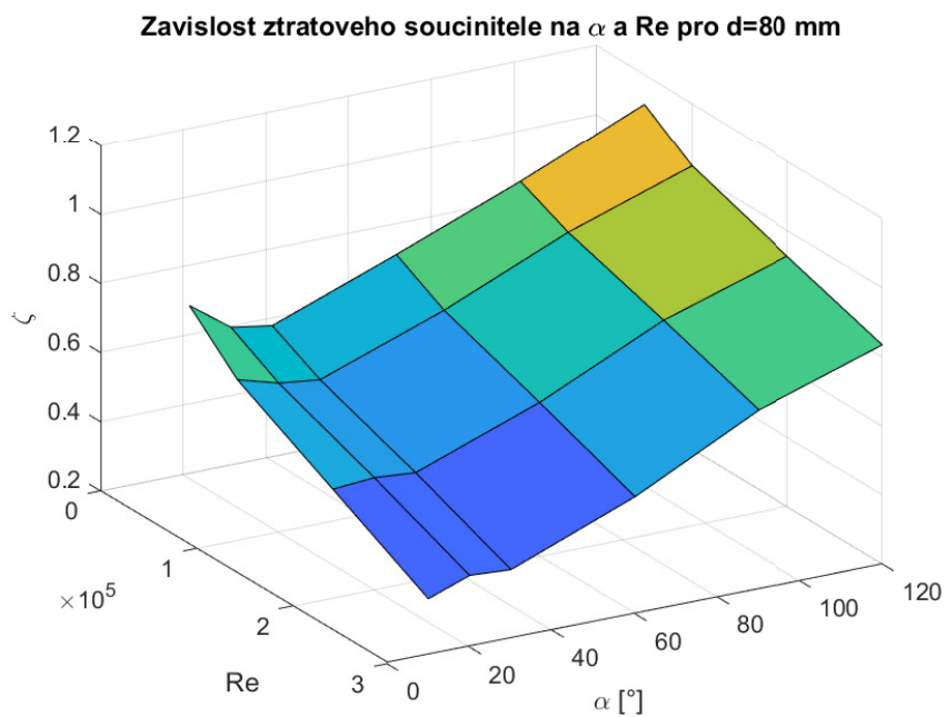
Obr. 17: Graf závislosti ztrátového součinitele \zeta na vrcholovém úhlu \alpha a Reynoldsově čísle Re pro průměr výstupní trubky d = 80 mm
