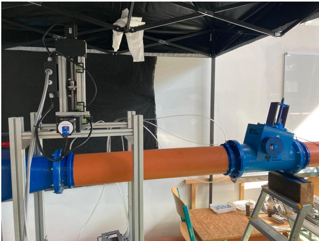
Obr. 1: Zpětná klapka ve zkušební trati během experimentálního měření
