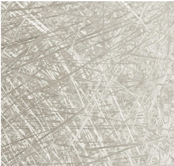
obrázek 20. - textura samotné skelné rohože
