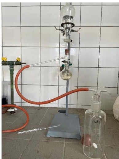
Obr. 14 Aparatura na sycení roztoku amoniaku a chloridu sodného oxidem uhličitým
