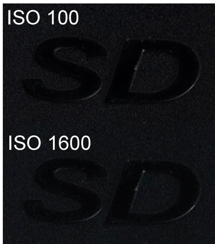
Obrázek 3: Porovnání hladiny šumu při ISO 100 a ISO 1600
