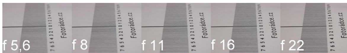
Příloha 3: Hloubka ostrosti při různých clonových číslech, ohnisková vzdálenost 50 mm
