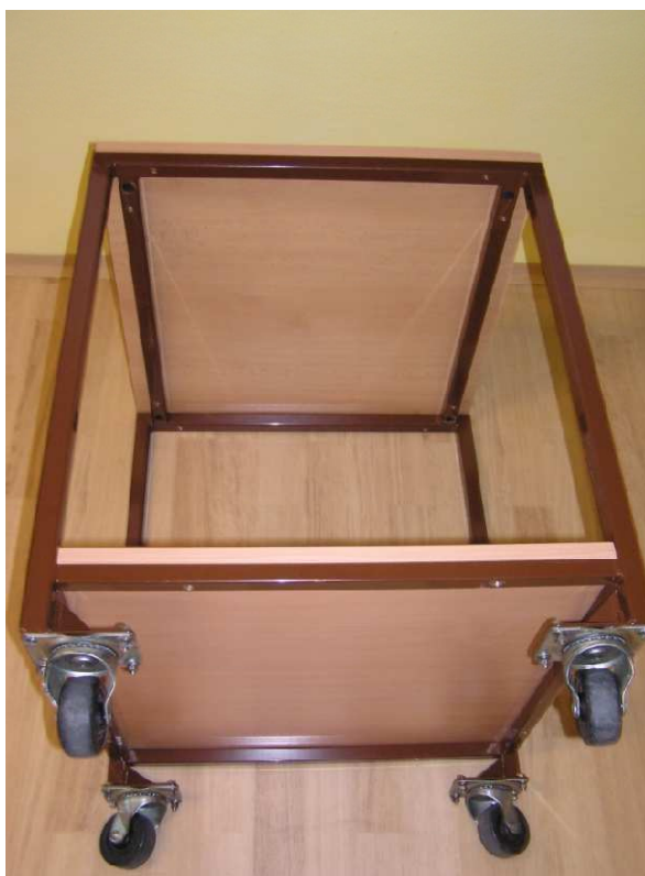
Obrázek 10 - Podstavec pod datový rozvaděč
