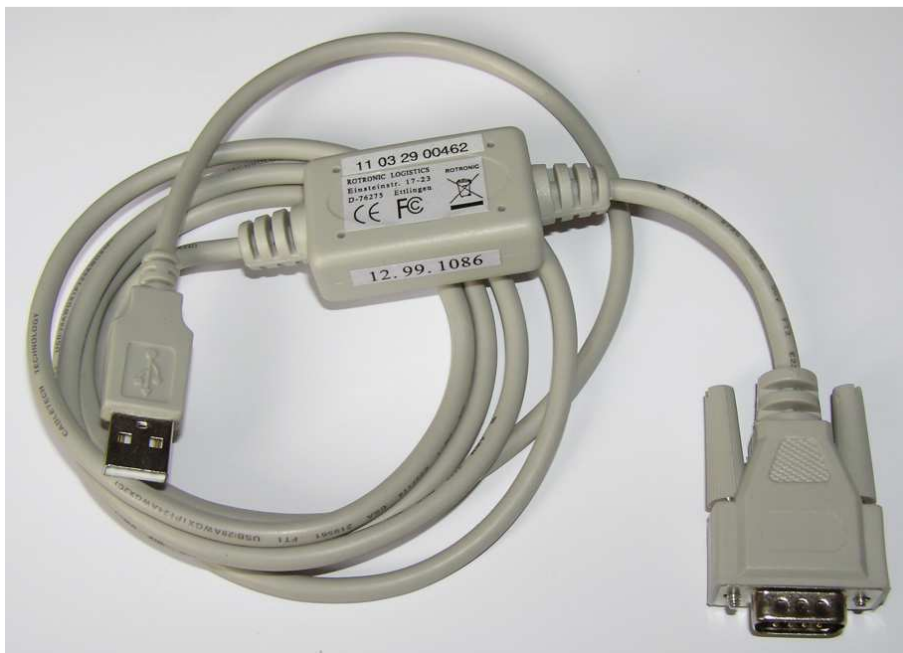
Obrázek 5 - Spolehlivě funkční provedení převodníku COM na USB
