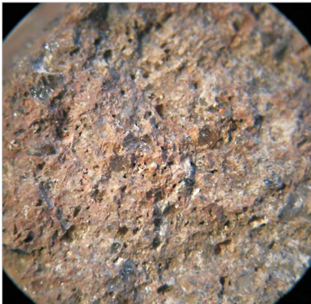
Obr. 24. Detail vnitřní porézní struktury ignimbritu s útržky křemenných skel, zvětšeno 6 x.
