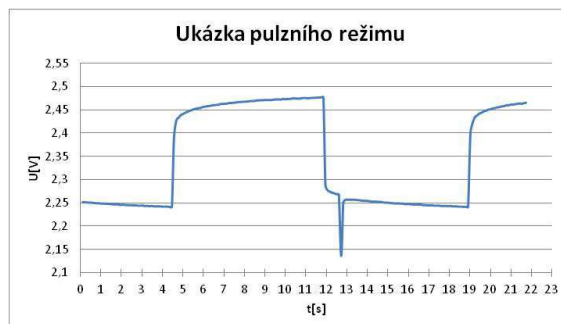
Obr. 1: Ukázka průběhu napětí na článku při použitém pulzním režimu
