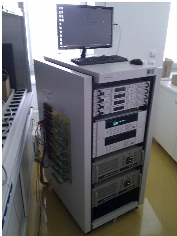
Obr. 3: Ústředna na platformě Agilent řídící celý experiment
