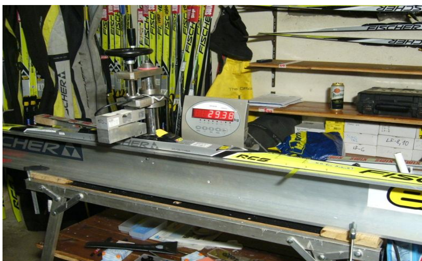
Obr. 15 Přístroj na měření tvrdosti každé lyže jednotlivě
