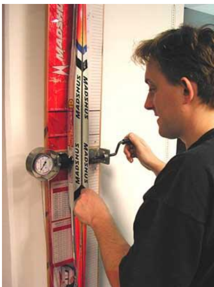
Obr. 14 Přístroj na měření tvrdosti lyží současně
