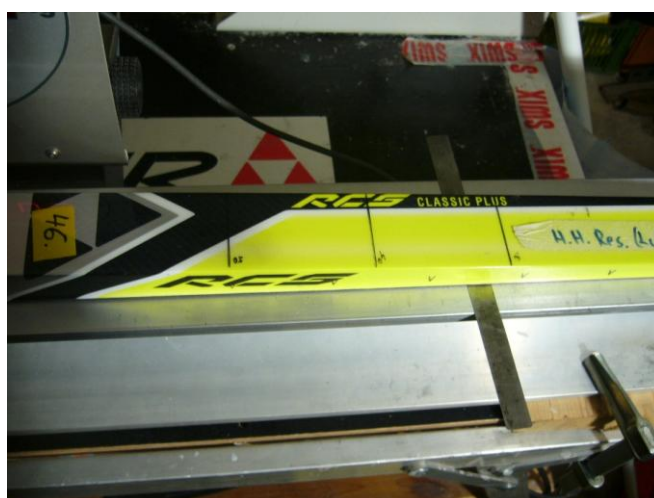
Obr. 16 Zatížená lyže při podsouvání kalibrovaného listu
