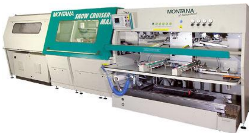
Obr. 19 Přístroj Montana pro strojovou povrchovou úpravu
