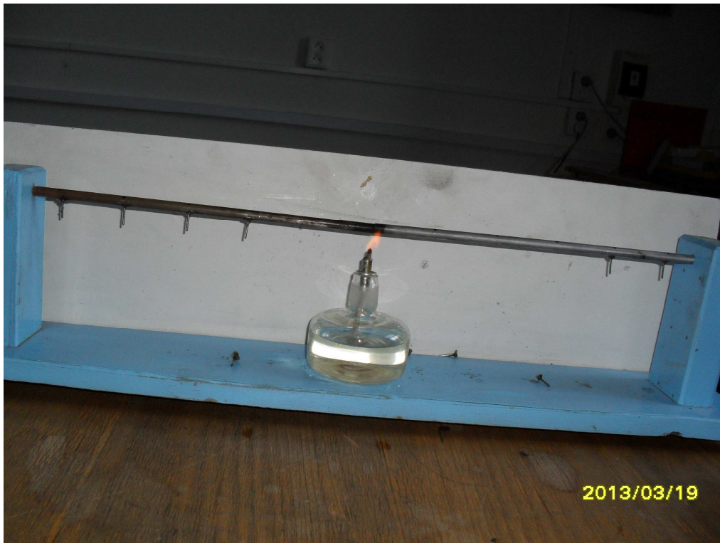
Obrázek 6: Uspořádání pokusu zahřívání tyčí z různých kovů
