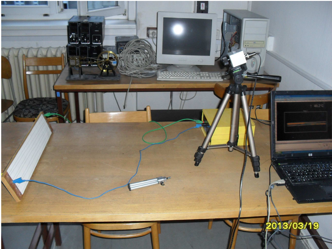
Obrázek 16a: Uspořádání experimentu s odporovým drátem
