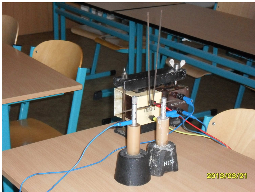
Obrázek 14a: Uspořádání experimentu s Jákobovým žebříkem
