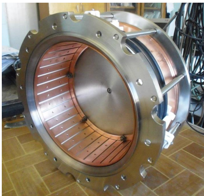
Obr. 8 – Vysokofrekvenční iontový zdroj (frek. – 4 MHz, max. VF výkon – 30kW, max. VF napětí na anténě – 8 kV) [9]
