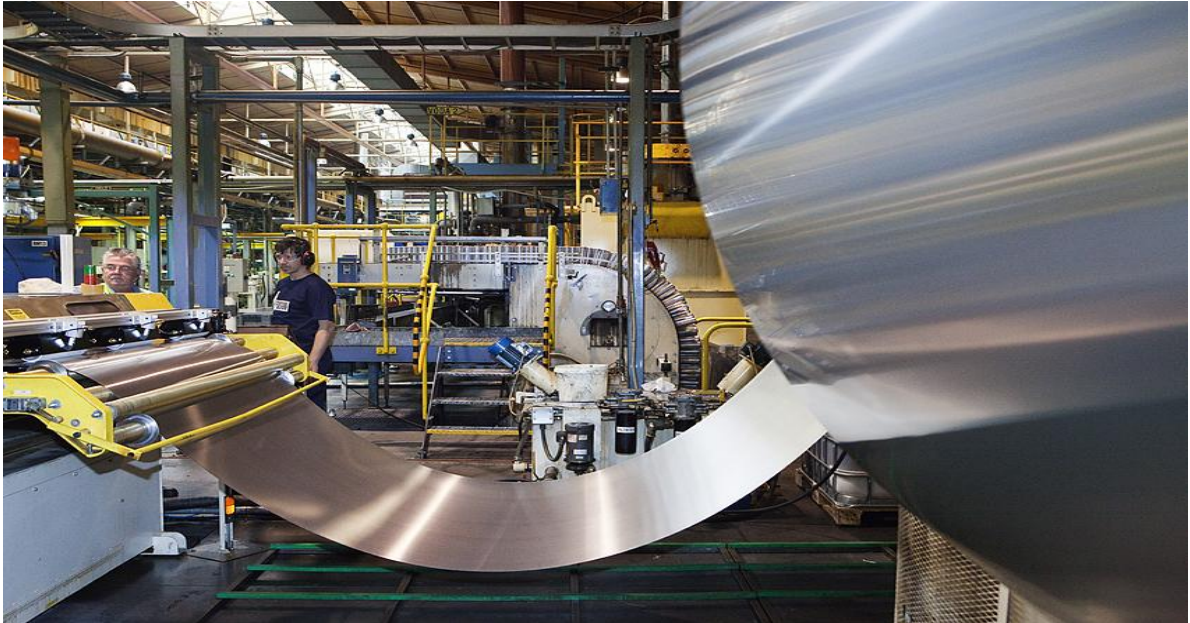
Obrázek 3.1 Příprava pro hlubokotažný lis ve společnosti Rexam Beverage Can Czech Republic, s.r.o. [14]
