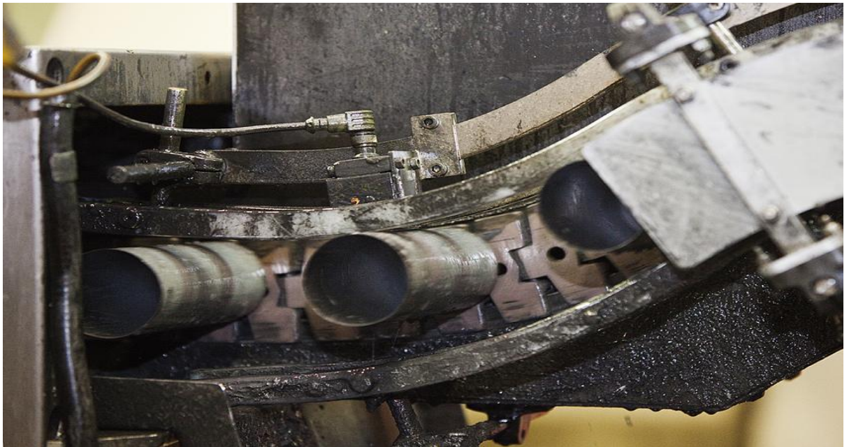
Obrázek 3.2 Nanášení vnějšího povlaku ve společnosti Rexam Beverage Can Czech Republic, s.r.o. [14]
