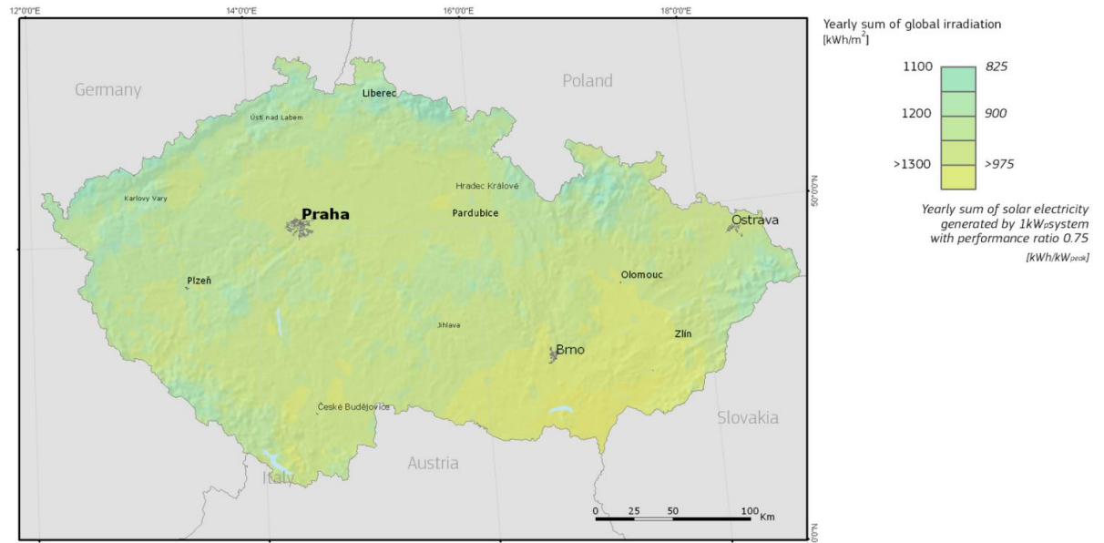
Obr. 22 - Dopad slunečního záření při optimálním natočení FV panelů [42]
