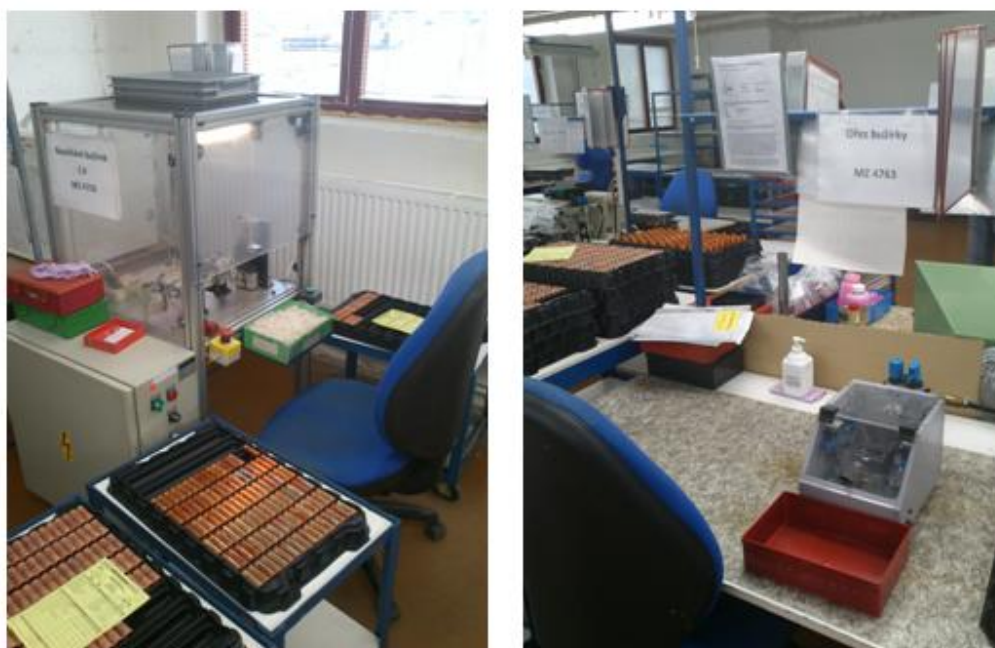
Obr. č. 4- 5 Navlékání a ořez bužírek
