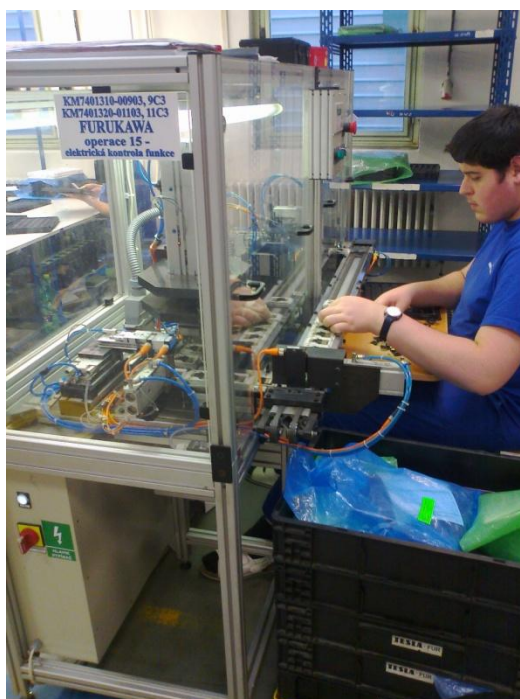
Obr. č. 4- 9 Elektrická funkční kontrola
