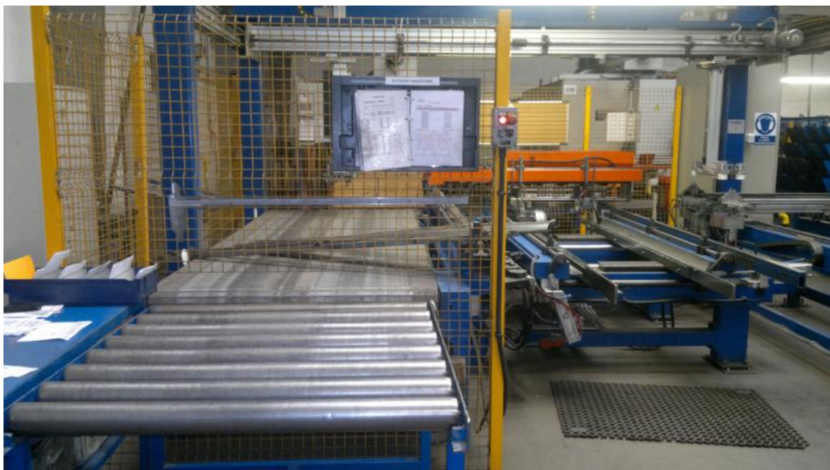
Obrázek 42: Výstupní pásový dopravník sezazovacího automatu D123
