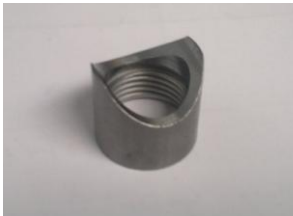
Obrázek 38: Přívod vody bodovaný na spodní trubku tělesa
