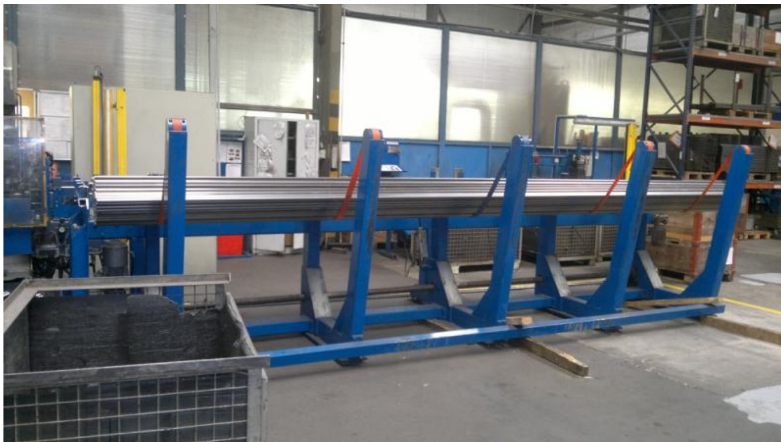
Obrázek 16: Pila pro dělení příčných trubek topných těles
