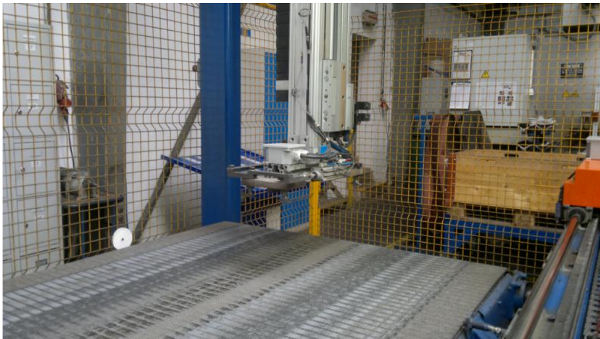
Obrázek 35: Mechanická ruka nad výstupním pásovým dopravníkem
