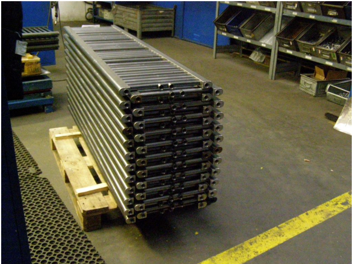
Obrázek 39: Topná tělesa Basic 50 po procesu bodování
