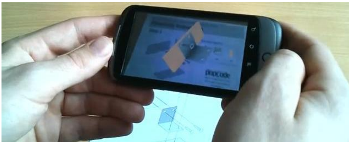
Obr. 3.17 Interaktivní návod na sestavení nábytku pomocí Augmented Reality za asistence mobilního telefonu [29]
