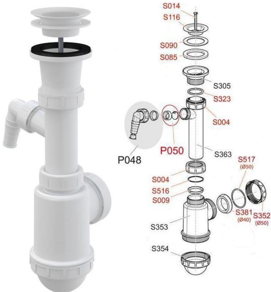
Obr. 6.2 Schéma montovaného sifonu [50]
