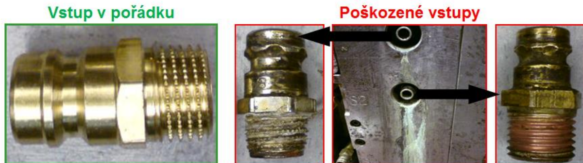
Obr. 5.3 Náhled části fotografického standardu míry poškození vodních vstupů [vlastní zpracování]
