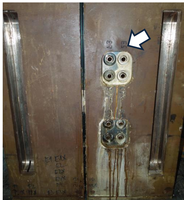
Obr. 5.1 Příklad poškozeného vodního vstupu na nástroji
