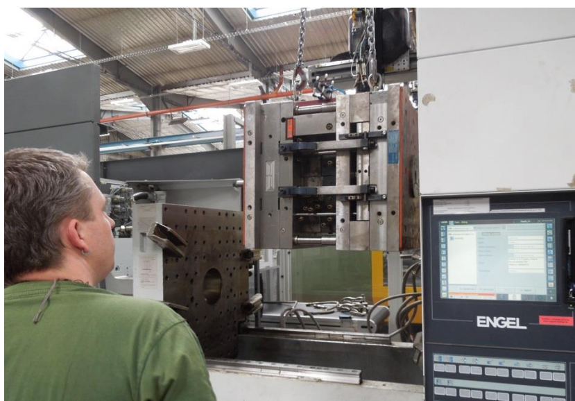
Obr. 4.7 Vyjímání lisovacího nástroje seřizovačem po ukončení výrobní dávky na lisu A-D28 [vlastní zpracování]
