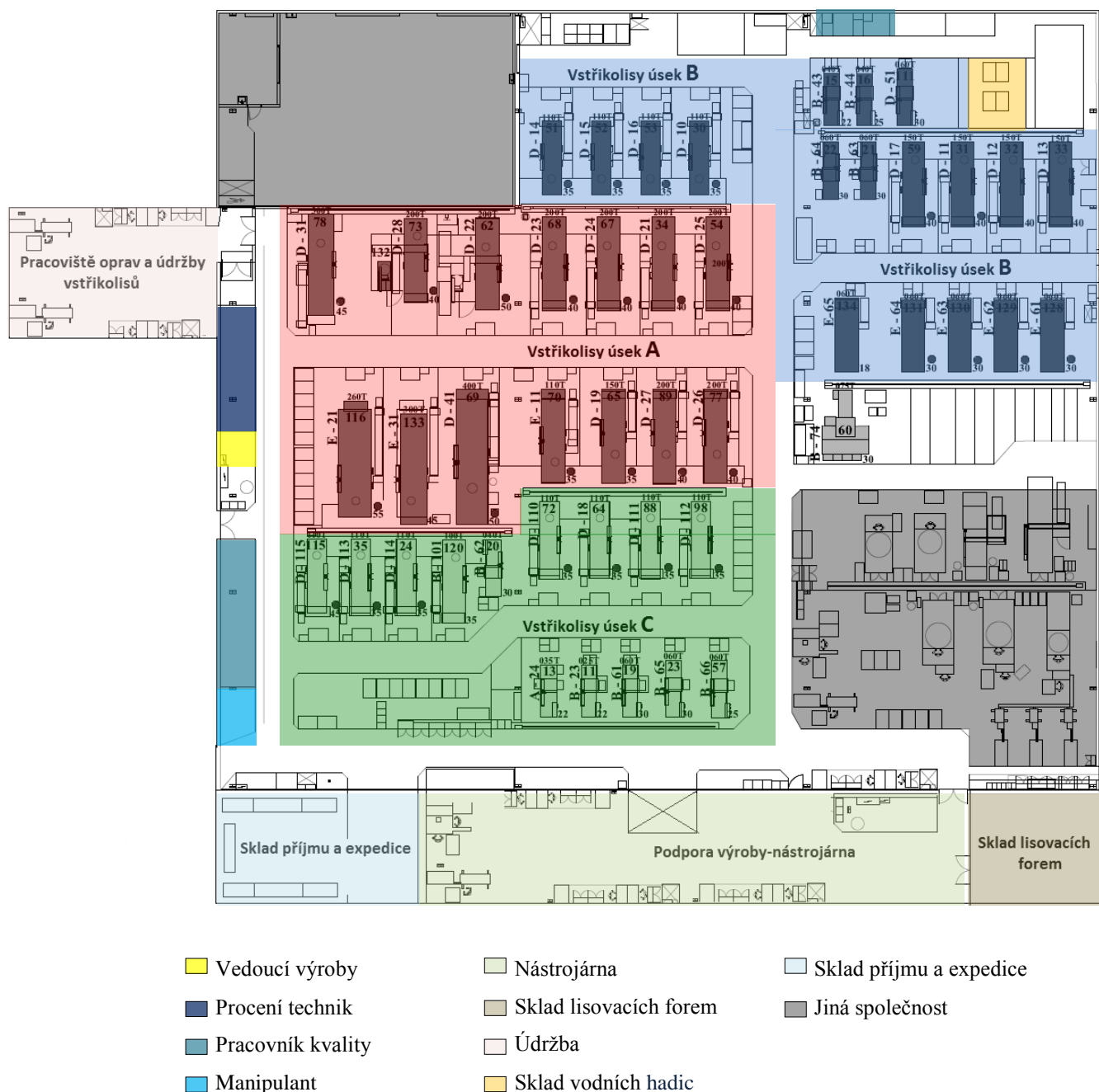
Obr. 4.3 Umístění pracovišť a výrobních úseků závodu lisovna [vlastní zpracování na základě podkladů společnosti]
