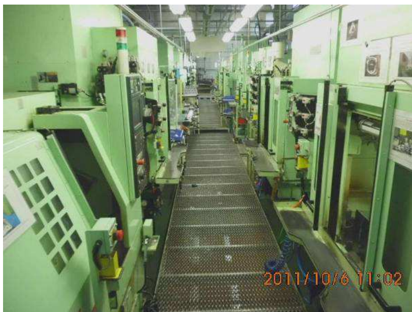
Obr. 4-2 Pohled na linku, vlevo vpředu soustruh a vpravo obráběcí centrum (Interní zdroj)
