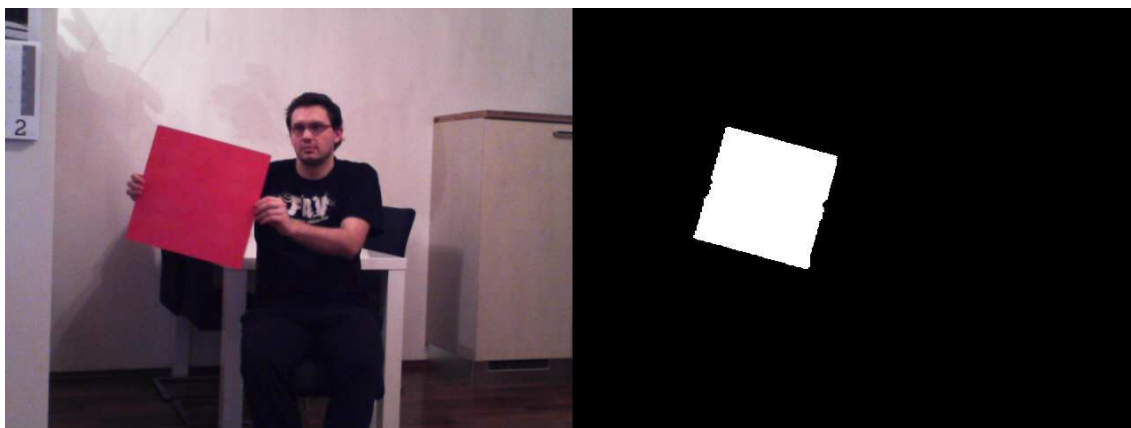
Obrázek 8.5: V levé části je zobrazen pohled na obrazovou scénu a trénovaný barevný obrazec. V pravé části se nachází odpovídající ruční segmentace červeného trénovacího obrazce.
