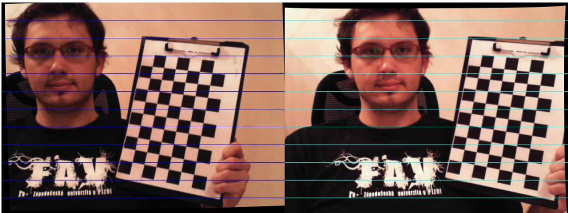
Obrázek 4.3: Rektifikovaná dvojice obrázků, ve kterých si jednotlivé řádky odpovídají.
