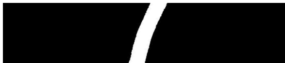
Obrázek 16: Prahování obrazu - metoda Otsu
