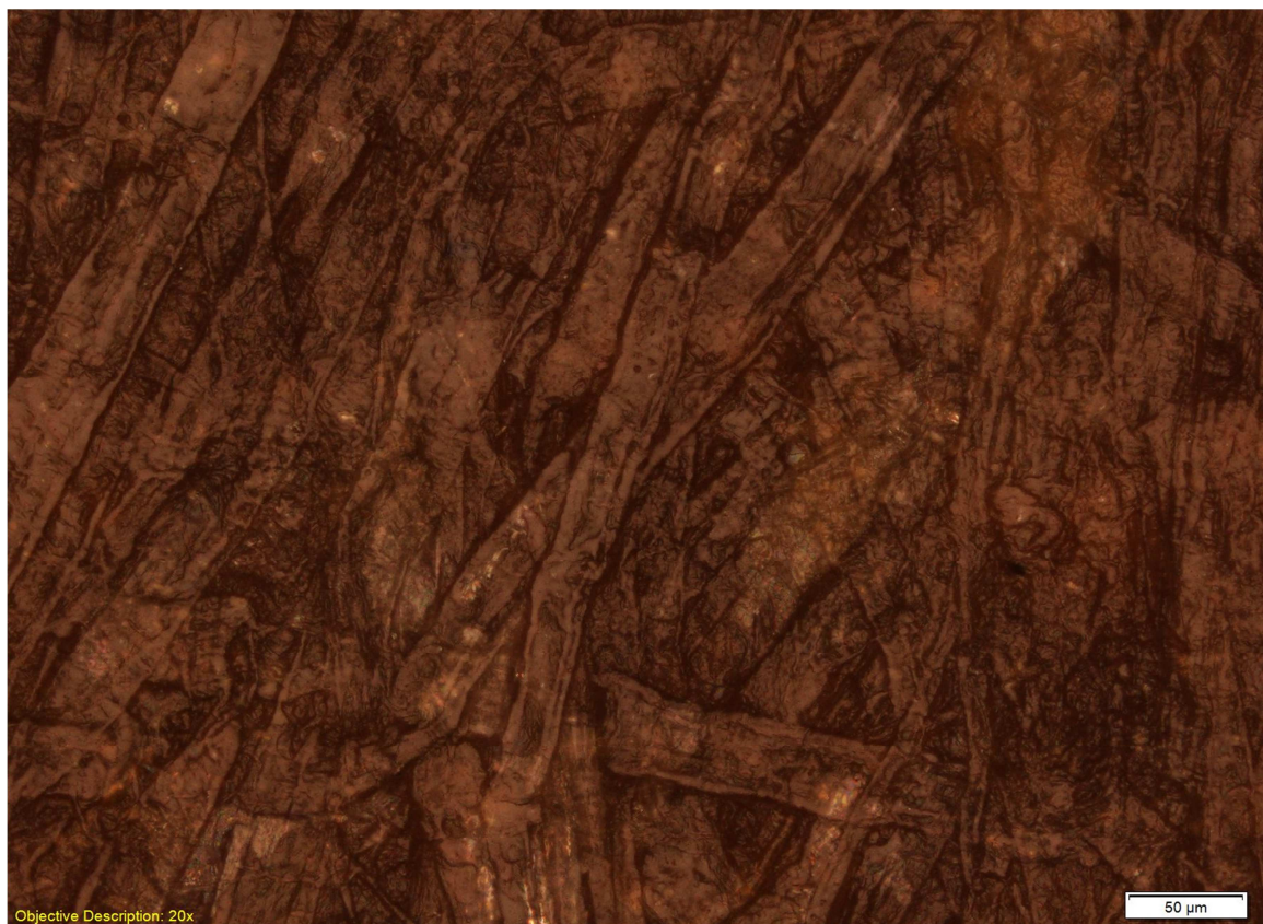
Obr. 7: Mikroskopický snímek dodaného stavu transformátorové lepenky
