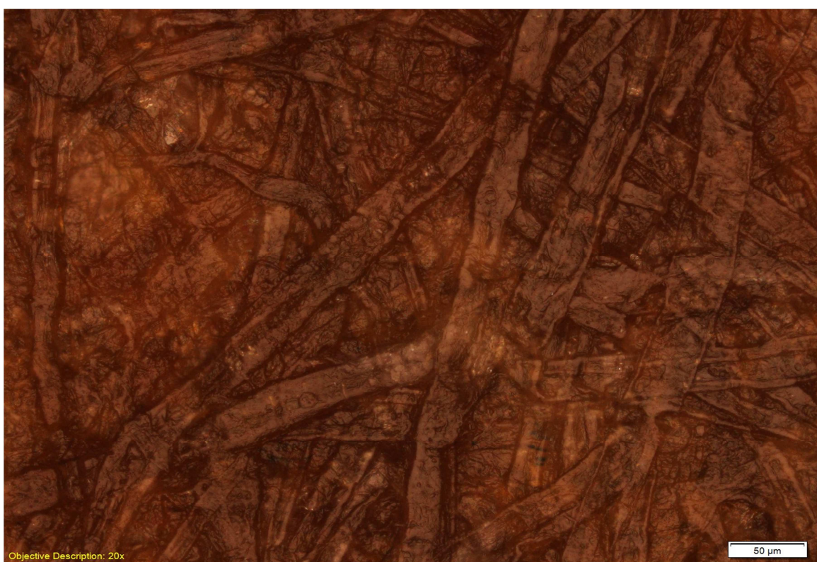
Obr. 8: Mikroskopický snímek stárnuté transformátorové lepenky po dobu 840 hodin
