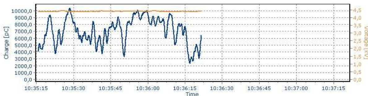
Obr. 25: Záznam výbojové činnosti při uspořádání hrot - deska ve vzduchu po dobu 1 min
