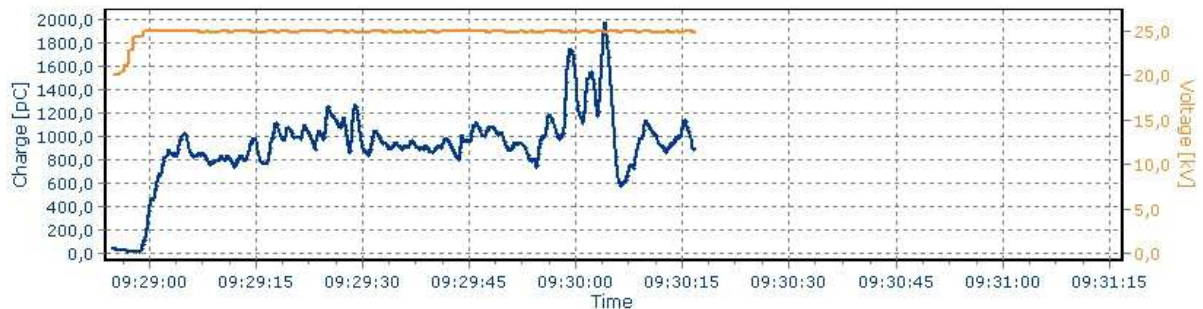
Obr. 19: Výbojová činnost pro čistý minerální olej MOGUL TRAFO s lepenkou
