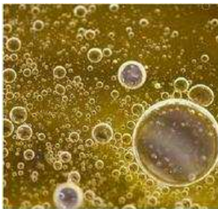
Obr. 4: Plynová bublinka v kapalném izolačním systému transformátoru, převzato z [11]
