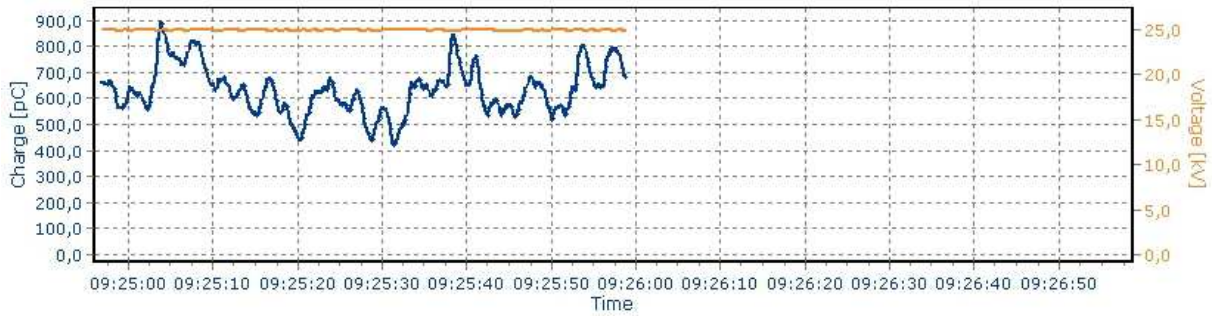
Obr. 21: Výbojová činnost pro čistý minerální olej MOGUL TRAF0 s lepenkou
