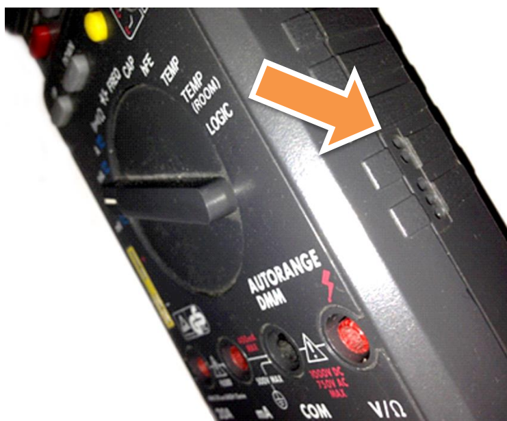
Obr. 2.3: Konektor na pravé straně multimetrů Metex pro připojení RS-232C
