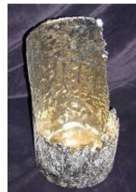
Obr. 3.2: Zbylá pevná vrstva po odlití roztaveného titanu z kelímku (převzato z [16])
