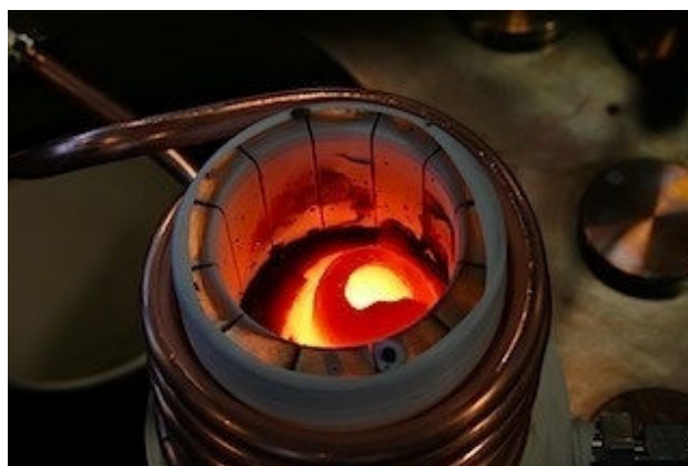
Obr. 6.3: Ukázka tavení ve studeném kelímku (převzato z [24])
