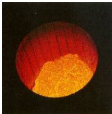
Obr. 3.1: Polo-levitační tavení titanu ve studeném kelímku (převzato z [16])
