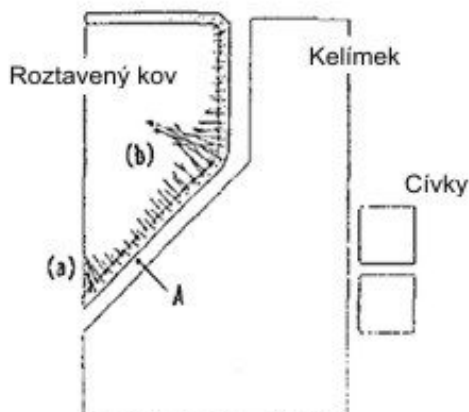
Obr. 2.5: Rozložení elektrodynamických sil na povrchu roztaveného kovu v kuželovitém kelímku (převzato z [6])
