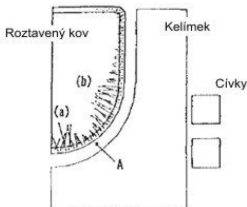
Obr. 2.4: Rozložení elektrodynamických sil na povrchu roztaveného kovu v konvenčním kelímku (převzato z [6])
