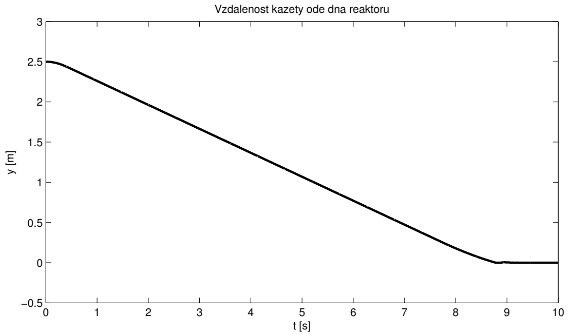
Obrázek 5.11: Časový průběh vzdálenosti dolního konce kazety ode dna nosného válce za klidu při nastavení ustálené rychlosti pádu na 0,3 \text{ m}\cdot\text{s}^{-1} .
