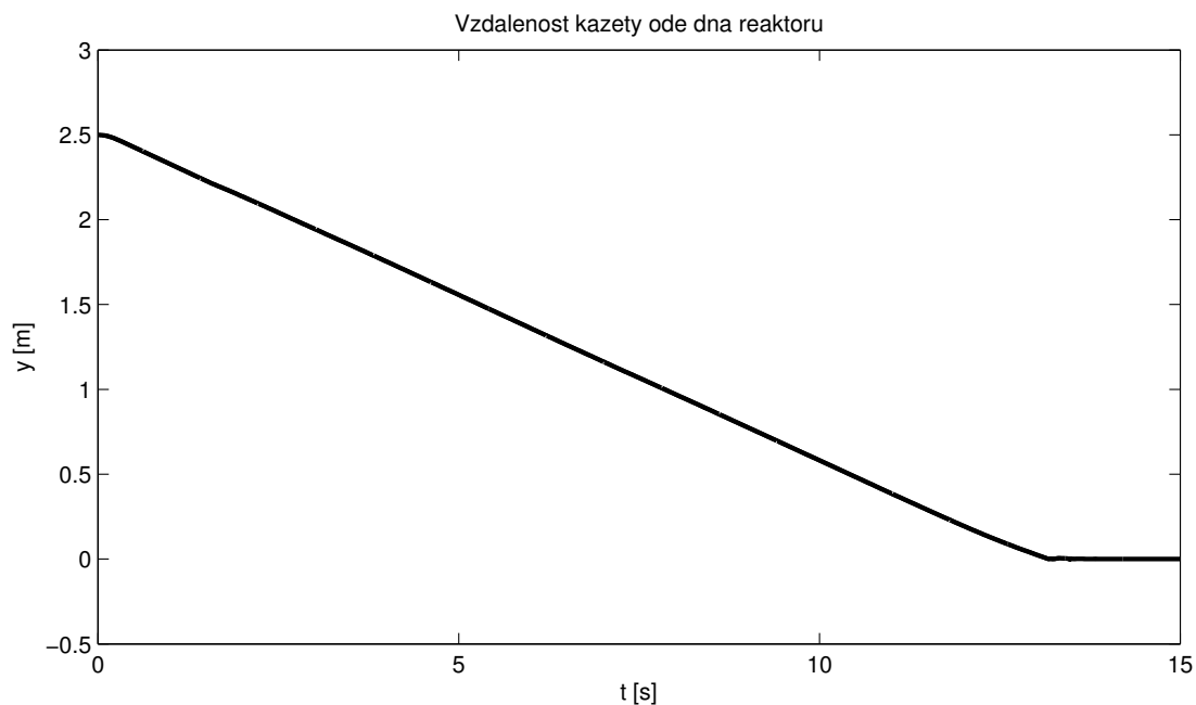
Obrázek 5.9: Časový průběh vzdálenosti dolního konce kazety ode dna nosného válce za seizmické události při nastavení ustálené rychlosti pádu na 0,2 \text{ m}\cdot\text{s}^{-1} .
