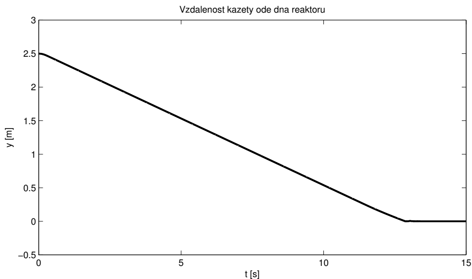
Obrázek 5.7: Časový průběh vzdálenosti dolního konce kazety ode dna nosného válce za klidu při nastavení ustálené rychlosti pádu na 0,2 \text{ m}\cdot\text{s}^{-1} .
