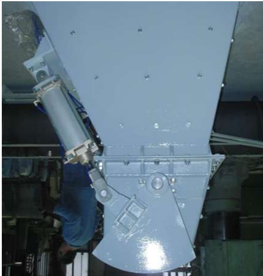
Obr. 16 Jednoduchý segmentový uzávěr s pneumatickým pohonem 22
