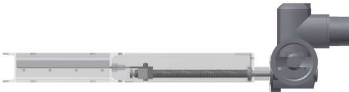
Obr. 38 Pohled na pohybový mechanismus zasazený do rámu
