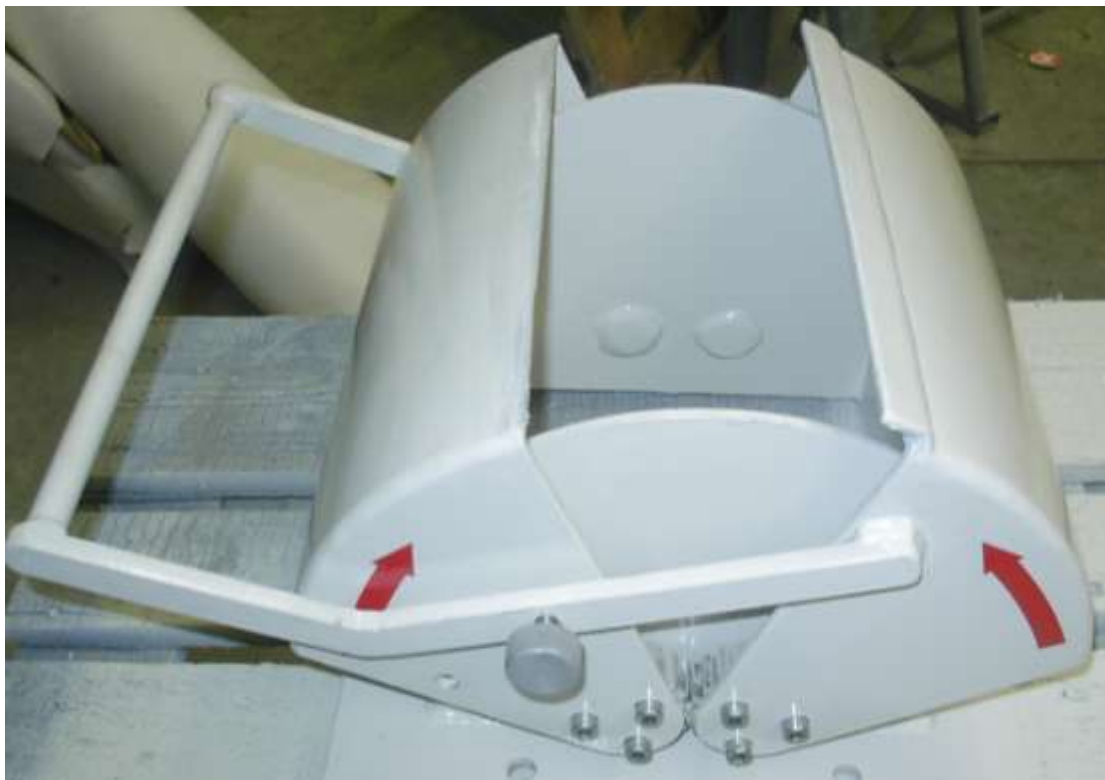
Obr. 17 Dvojitý segmentový uzávěr s ručním pohonem 23
