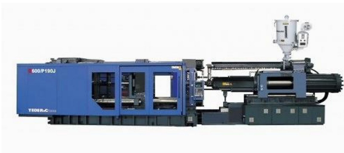
Obrázek 19 - Vstříkovací lis INTEC D600/P190J [9]
