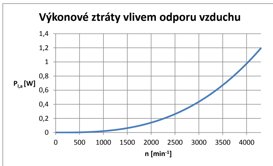
Graf 3 – Průběh ztrát vlivem odporu vzduchu v závislosti na otáčkách.
