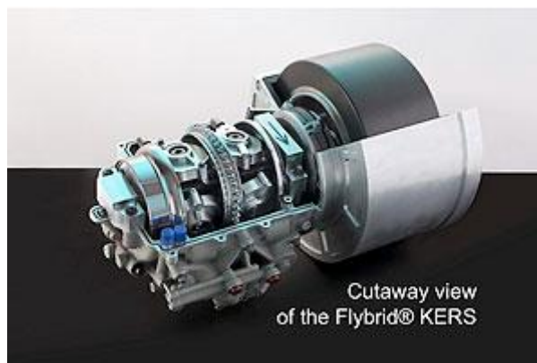
Obr. 11 - Setrvačnickový KERS společnosti Flybrid s technologií Torotrak CVT. [17]
