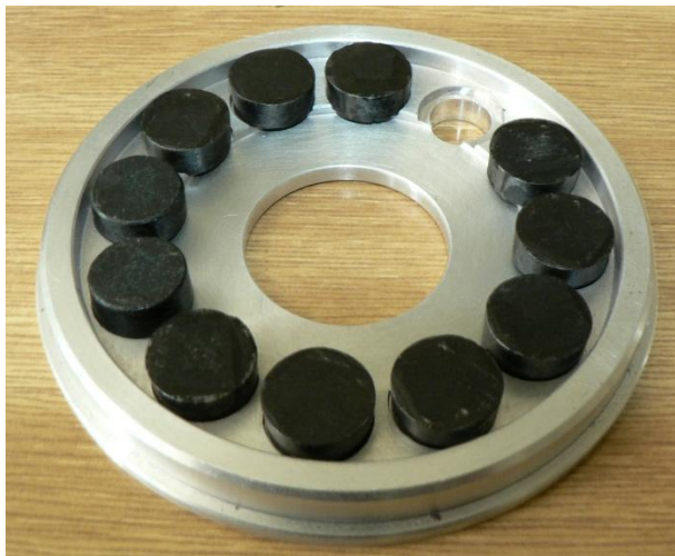
Obr. 48 – Fotografie disku s vyskládanými kotouči HTS.
