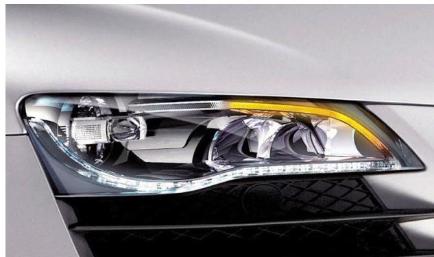
Obrázek 2-5 LED diodový světlomet Audi R8 [a03]
