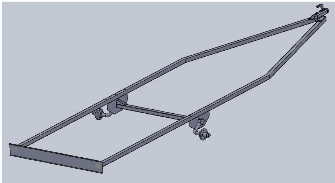
Obr. 15. Konstrukční návrh přívěsu – varianta 2. Celkový pohled.
