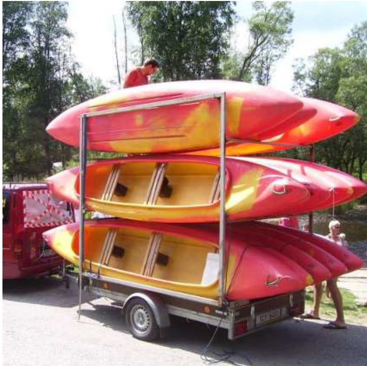
Obr. 7. Přívěs s odnímatelnou konstrukcí pro až 15 kanoí. Takový přívěs je možné koupit od výrobce přívěsů a od jiné firmy si nechat vyrobit odnímatelnou konstrukci. V tom případě je ale nutné provést homologaci a zápis do technického průkazu přívěsu.
