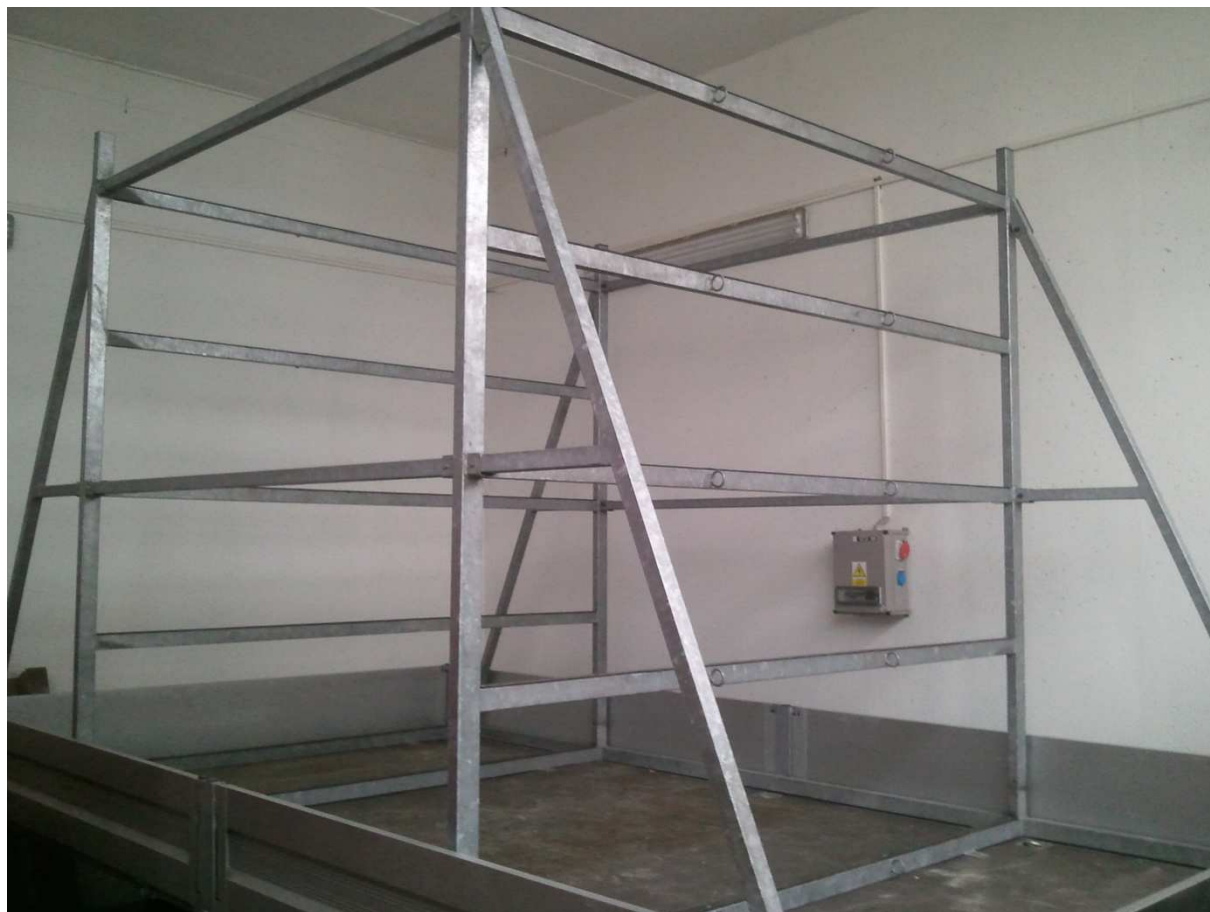
Obr. 10. Konstrukce na přívěsu, v přední části jsou zřetelně vidět oka pro uchycení lan
