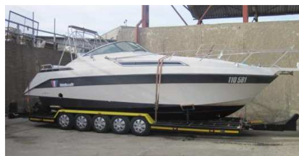
Obr. 6. Pětinápravový brzděný přívěs kategorie O3
