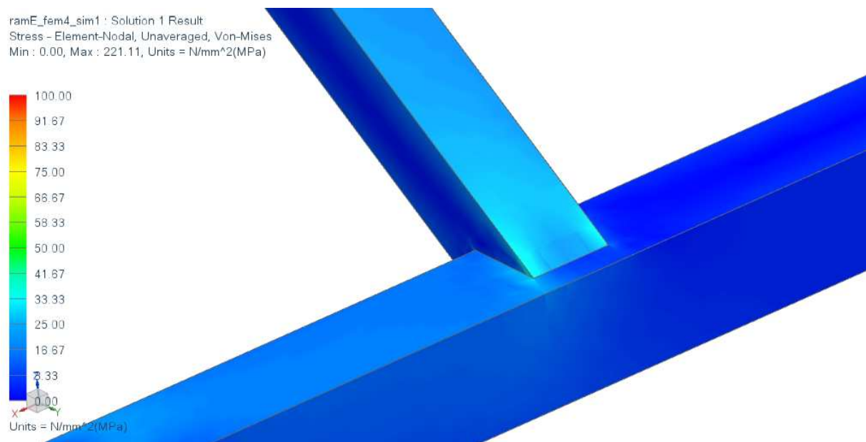
Obr. 54. Napětí kolem svaru u přední výztuhy je zcela v pořádku v mezích.
