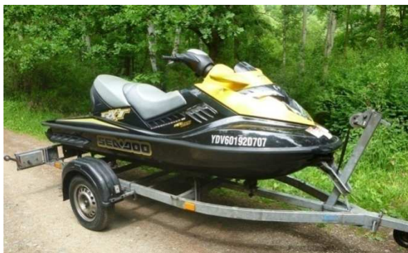
Obr. 3. Jednonápravový nebrzděný přívěs kategorie O1
