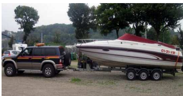
Obr. 5. Třínápravový brzděný přívěs kategorie O2
