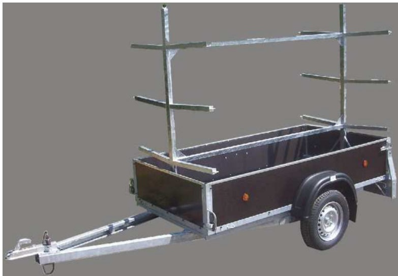
Obr. 8. Přívěs s odnímatelnou konstrukcí přímo od výrobce, v tomto případě je již přívěs plně homologován a není nutno dalších zápisů do technického průkazu přívěsu.
