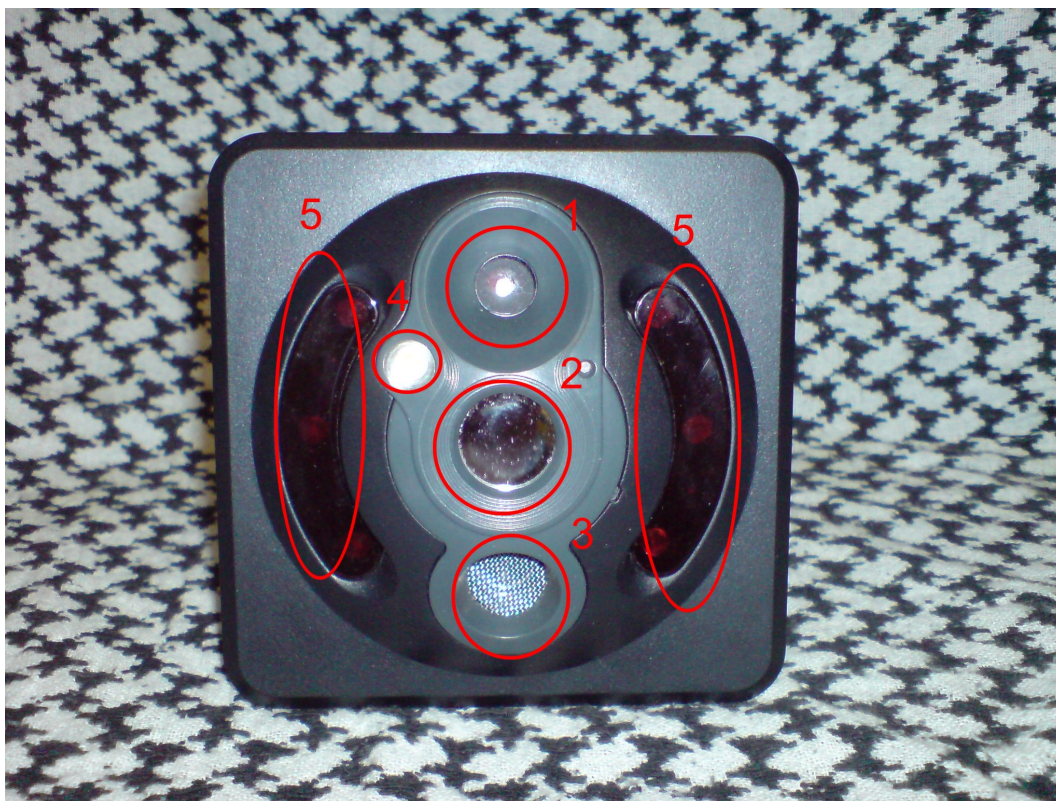
Obrázek 5.1: Přední část snímače oční duhovky. 1–Optika a vlastní CCD snímače 2–zrcátko 3–měřič vzdálenosti 4–Bílá LED dioda nahrazující blesk 5–Infračervené LED diody pro přísvit v módu snímání oční duhovky
