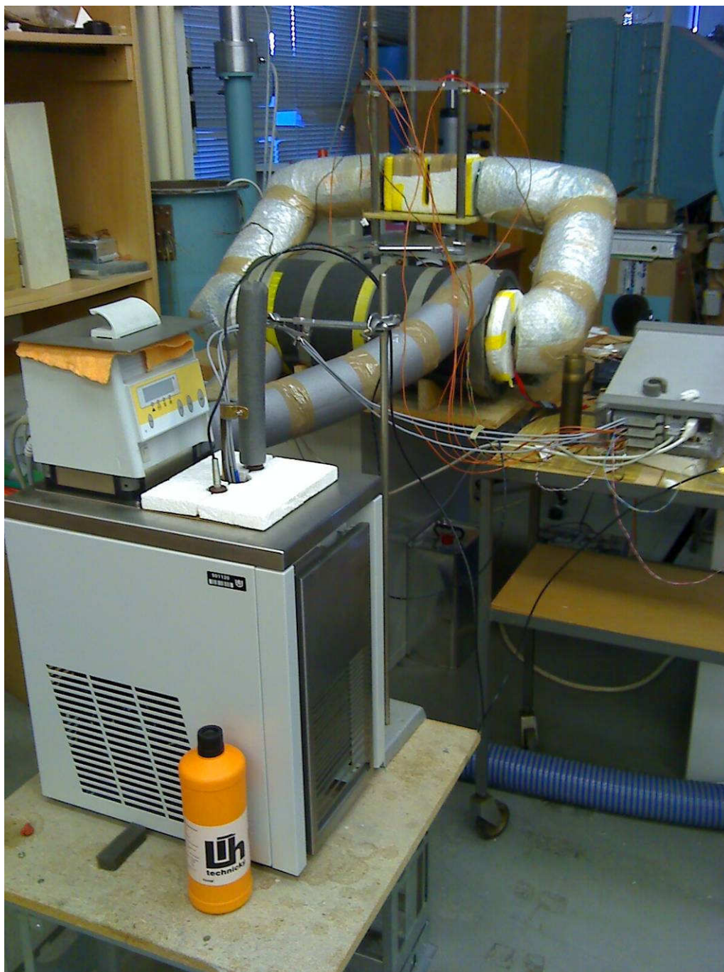
Obrázek 12: Zařízení z roku 2012 pro měření povrchového napětí vody
